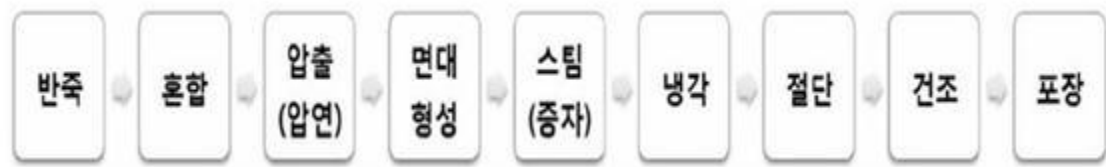
그림 31 .쌀국수의 일반적 제조과정 (쌀 가공기술 개발 및 가공산업 확대방안. 2010. 한국농촌경제연구원)
