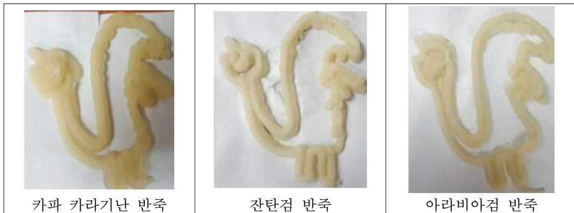
그림 3-14. 증점제 적용 반죽 프린팅 결과
