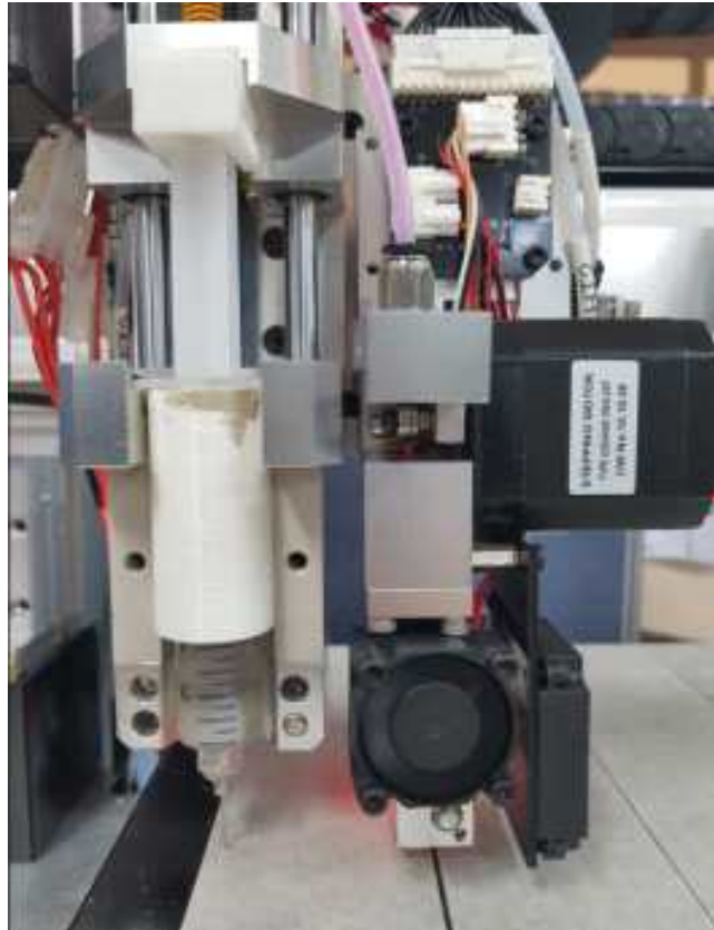
그림 1-7 압출기 모듈 제작 및 설치
