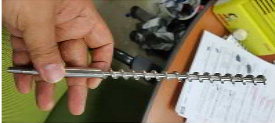
그림 1-32 가공된 Screw 부품 (SUS304)
