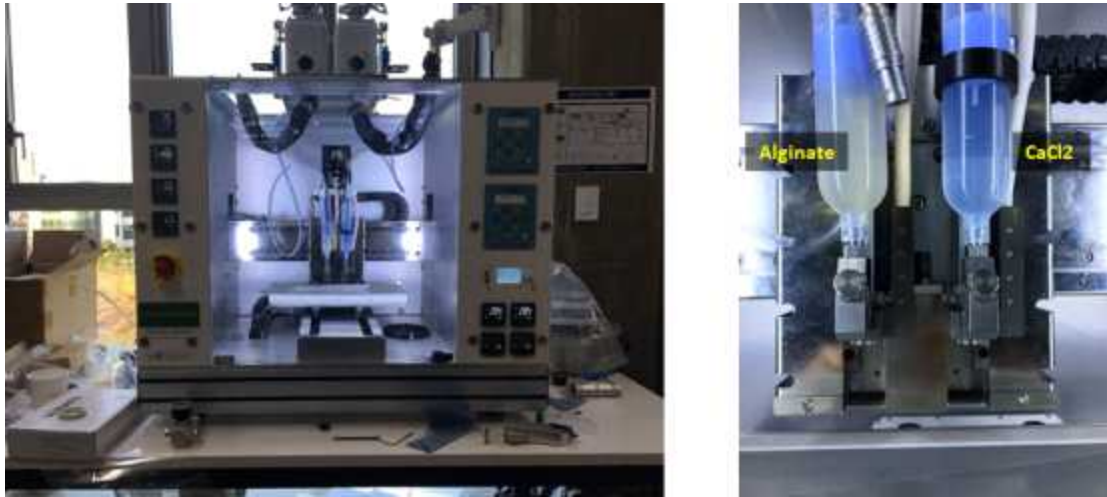
그림 1-99 알긴산 + 염화칼슘 액을 이용한 프린팅 공정 연구 진행사항
