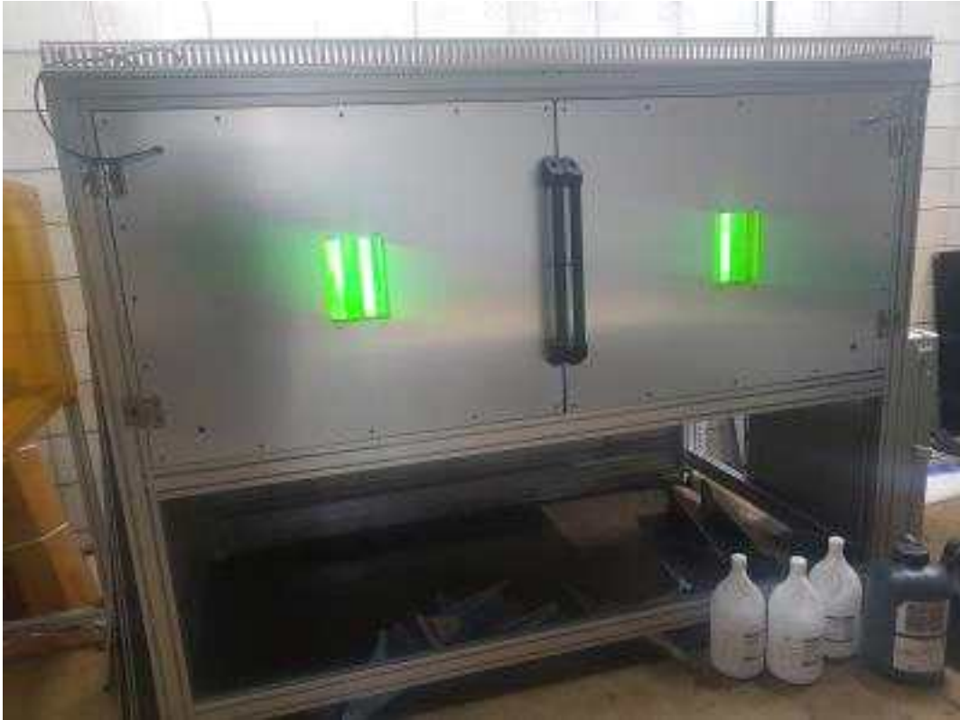
그림 1-102 살균장치 동작사진, 창에 UV 차단필름 설치
