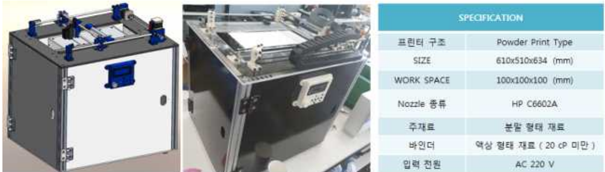
그림 1-44 버블젯 방식 3D 프린터 사진 및 사양서
