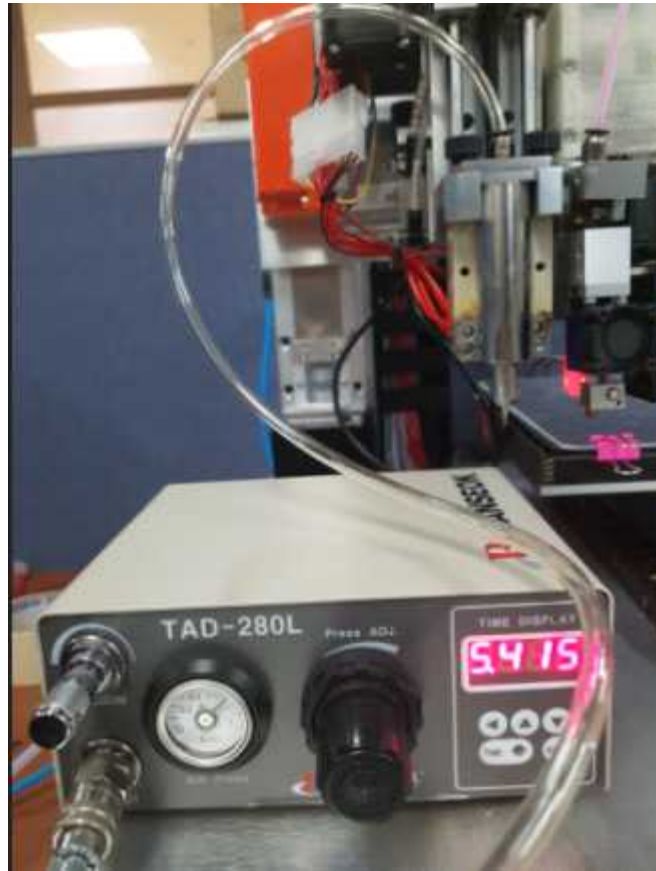
그림 1-20 공압 실린더 및 공압 제어장치
