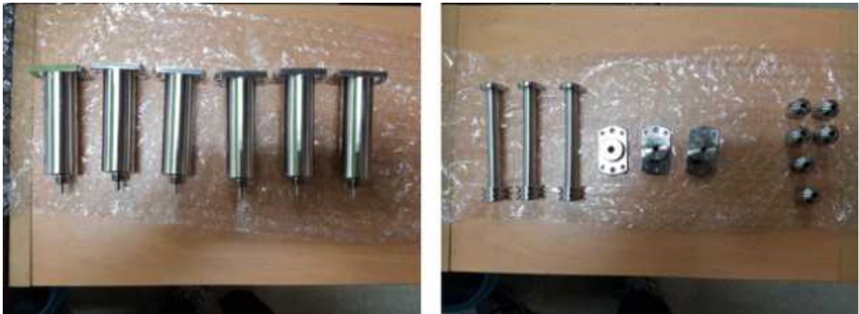
그림 1-11 실린더 블록 (좌) 및 피스톤, 실링블록, 노즐 고정 블록 (우)
