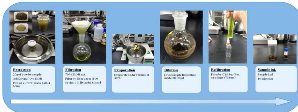
<그림. 마치현 시료의 분석을 위한 전처리 공정>
