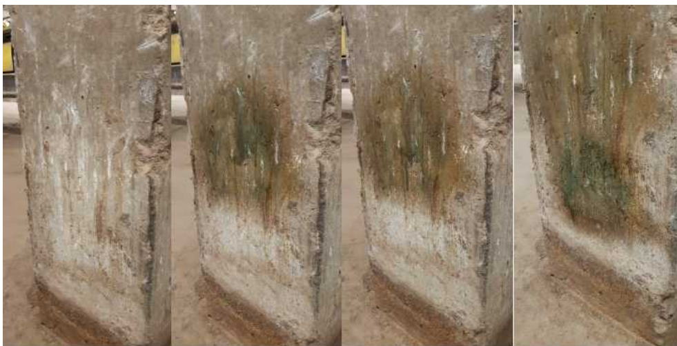
<그림42 계사 내 기둥에 색전이センサー 적용 전·후 비교 (좌측부터 : 색전이センサー 적용 전, 기둥 상단 적용 직후, 상단적용 30초 후, 하단 추가 적용 직후)>
