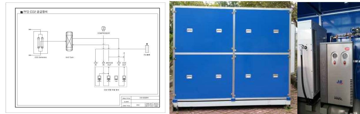
그림 50. 상용형 멤브레인 시스템의 개략도
