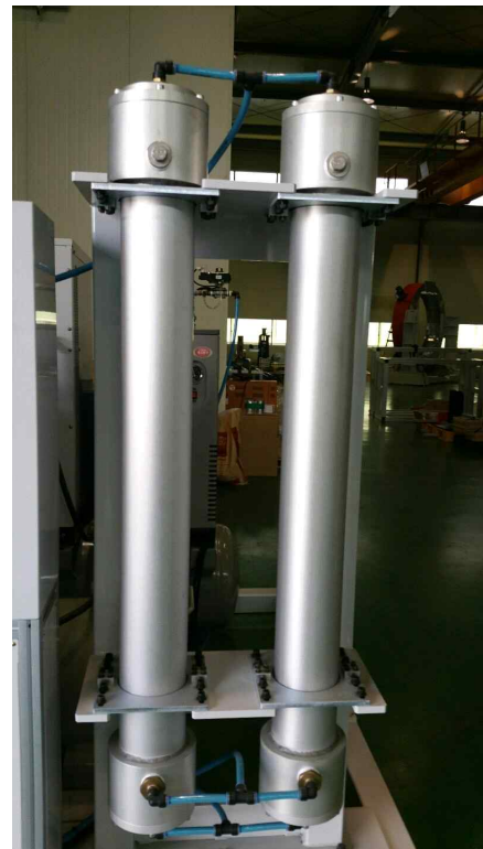
그림 29. 멤브레인 모듈 설계 및 제작
