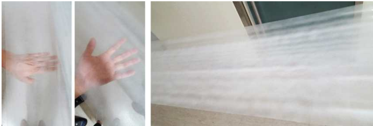
그림 31. PE 필름 표면에 방사된 나노섬유. 코팅 두께에 따라 투명도에 영향을 미침
