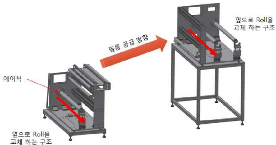
그림 83. Roll to Roll 구조로 필름을 공급할 수 있는 구조의 설계 완료
