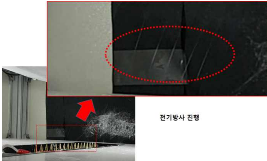
그림 22. 개발된 Pump와 노즐을 이용한 전기방사 진행되는 것을 확인함.
