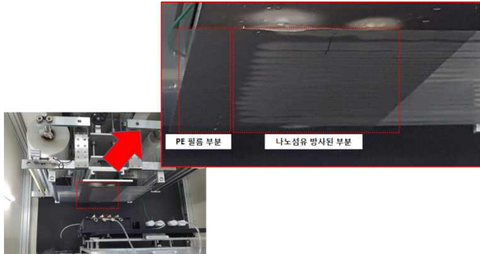
그림 25. PE 필름 표면에 방사된 나노섬유
