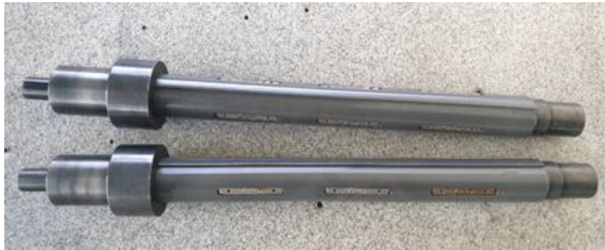
그림 103. 분해조립 가능한 타입 공급부 제작
