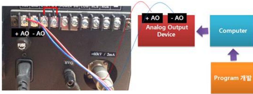
그림 60. 파워서플라이의 방전 전압을 제어 하기 위한 외부 접속 회로
