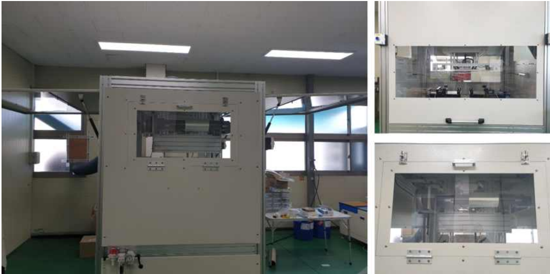
그림 98. 개폐형 도어 및 아크릴 전면부를 적용한 기구부 제작
