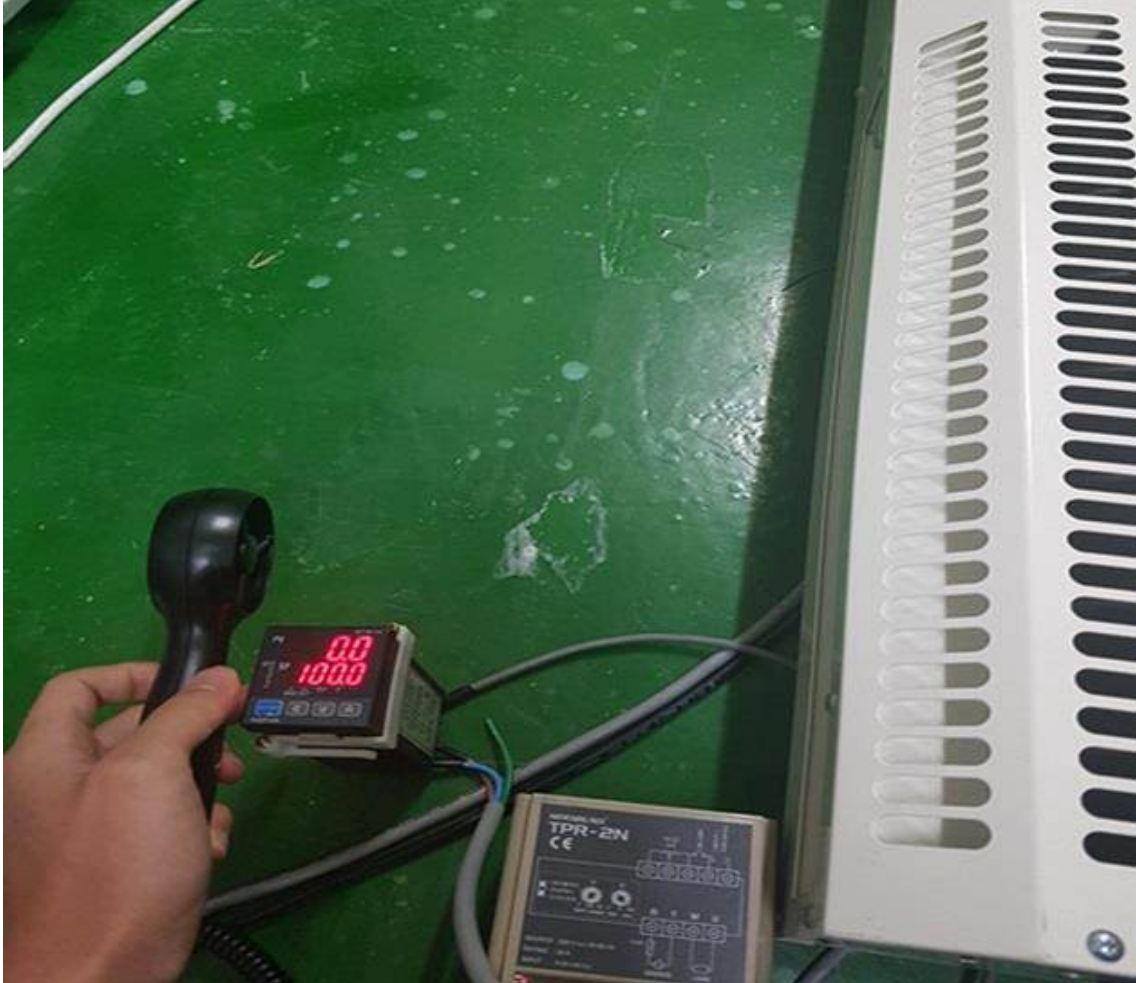
<풍속센서를 이용한 구동모터 전류 공급값에 따른 풍속측정 장면>
