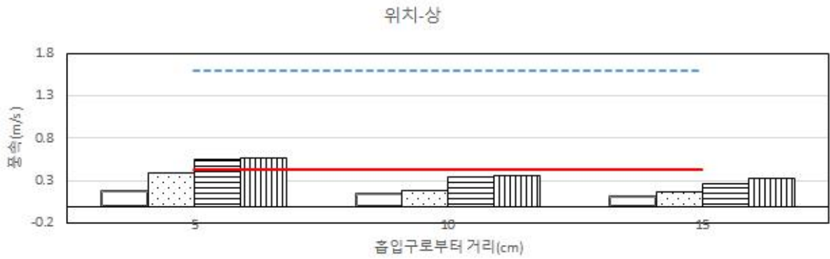
<흡기구 개수에 따른 위치별 흡입 풍속 테스트>
