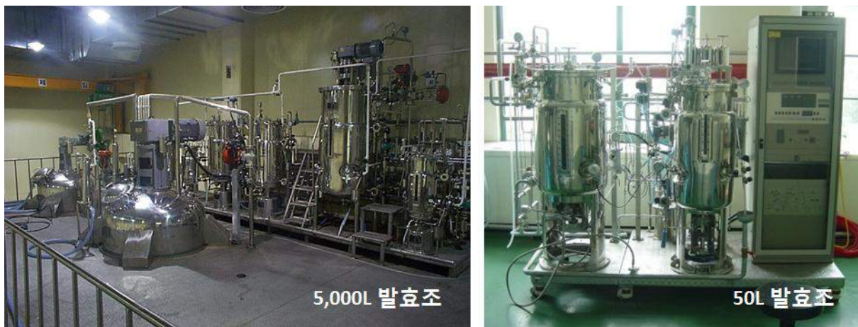
Figure 47. 면역조절소재(시제품) 생산을 위한 Pilot-scale의 5,000리터 발효조 및 50리터 발효조 생산설비 사진
