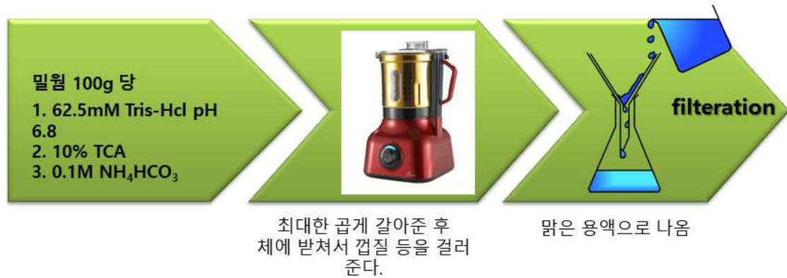
[Figure 11] 추출버퍼에 따른 Antifreeze protein 추출과정 모식도
