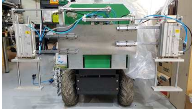
그림 50. 수평실린더 및 LM가이드 제작
