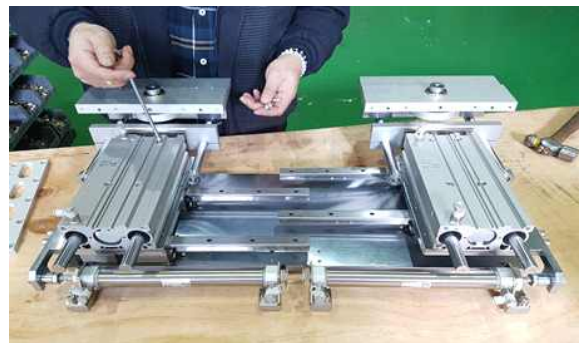
그림 18. 틸티 가이드 및 슬라이드 실린더 결속
