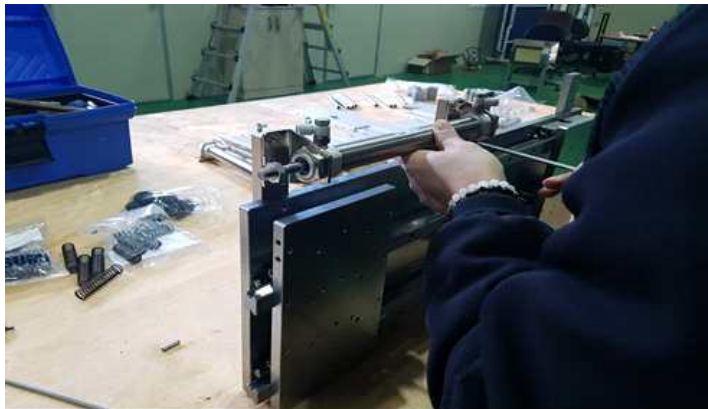
그림 15. 가이드 실린더 및 LM 가이드 제작
