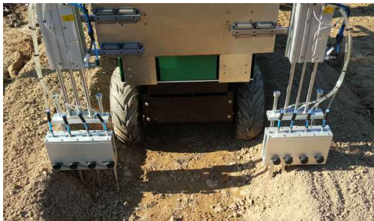
그림 60. 시제작 소형방제기 자체 시운전 Test
