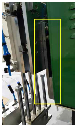
그림 45. 약액주입헤드장치 메인 플레이트 위치 변경
