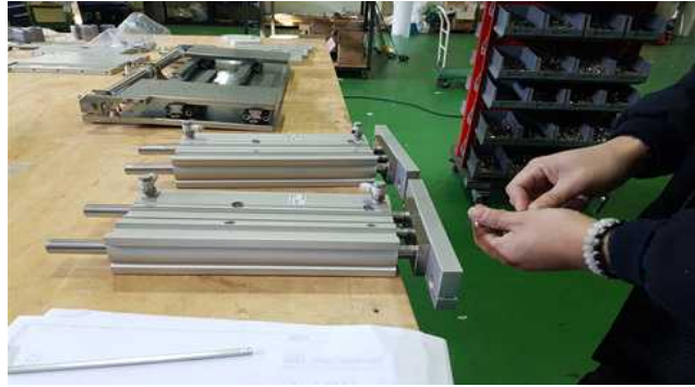
그림 16. 약액주입장치 가이드 박형 실린더 제작
