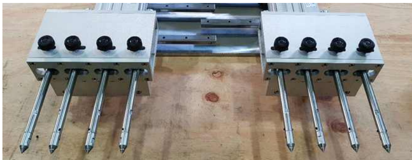
그림 4. 약액주입헤드장치 Ass'y 개발
