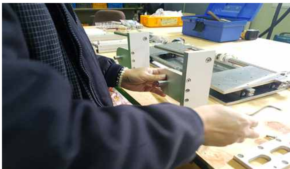
그림 18. 틸티 가이드 및 슬라이드 실린더 결속
