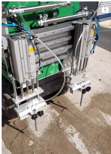
그림 59. 약액주입헤드장치 분출 Test (개선후)
