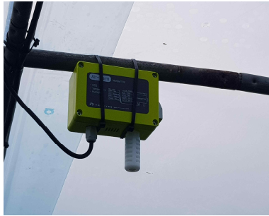
그림 2-32. 온도, 습도, CO2 센서 및 CCTV 설치
