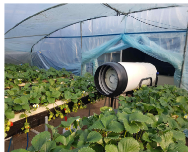
그림 2-31. DME 가스연소식 CO2 발생기 설치
