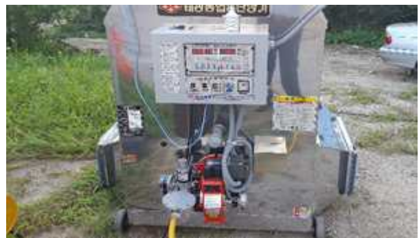
그림 2-10. 저NOx Burner 설치 온풍기
