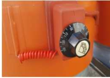
용기 가열 패드 설치
