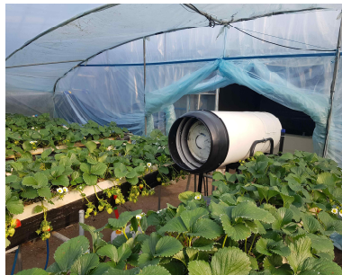
그림 2-33. 스마트 팜 통합관제시스템 및 CO2 발생기 설치
