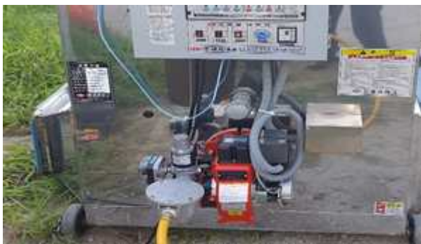
그림 2-10. 저NOx Burner 설치 온풍기
