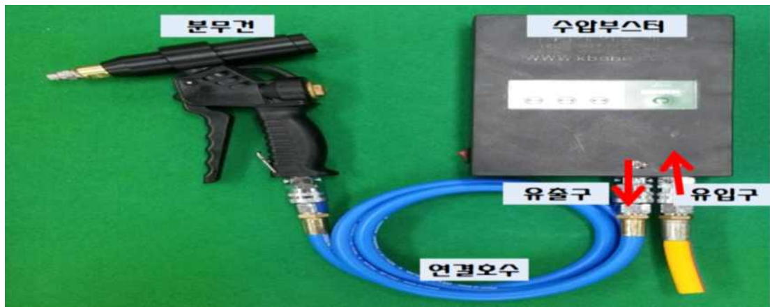
그림 37. 전자식 맥동형 분무건의 기본 구조
