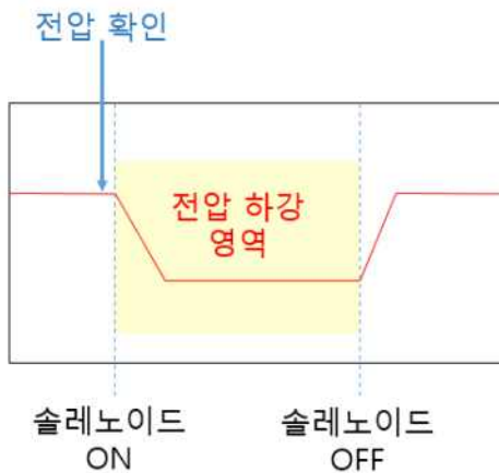
그림 10. 솔레노이드 밸브 ON일 때 전압 하강 현상
