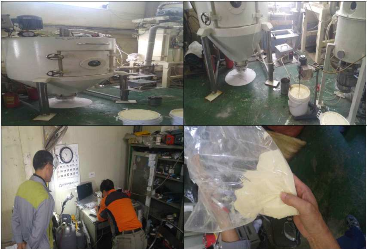
그림 3-2. 바이오황 분무 건조 테스트 사진.
