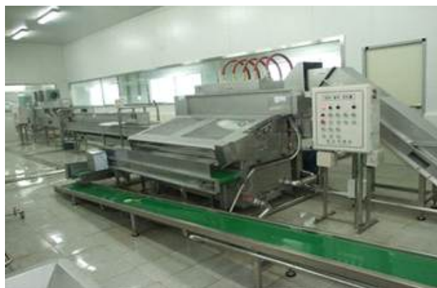
그림 3. D사 수압식 양파껍질탈피장치 설치모습
