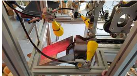
그림 58. 자바라 구조의 에어노즐(개선전) 그림 59. 회전파동 구조의 에어노즐(개선후)
