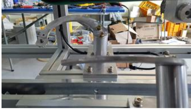
그림 6. 외피 절개용 스크래치 장치
