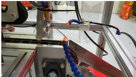
그림 58. 자바라 구조의 에어노즐(개선전) 그림 59. 회전파동 구조의 에어노즐(개선후)
