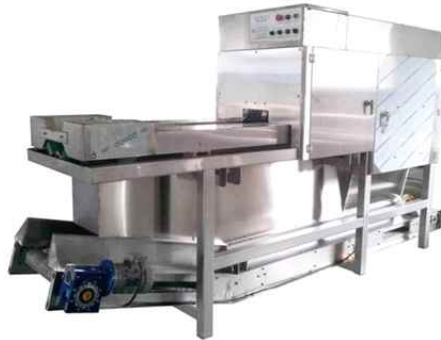
그림 2. S사 공압식 양파껍질탈피장치 설치모습
