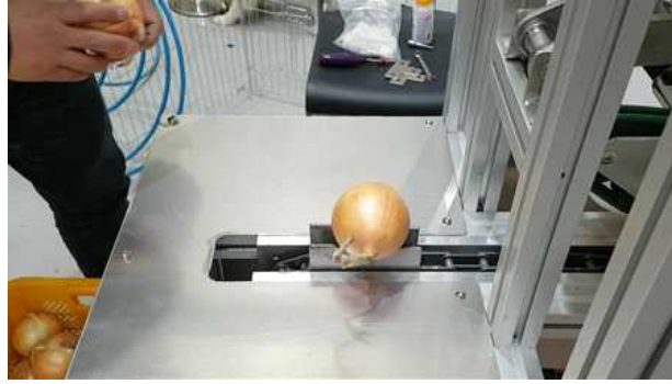
그림 22. 투입부(바스켓) 및 이송부(체인컨베이어) 구조
