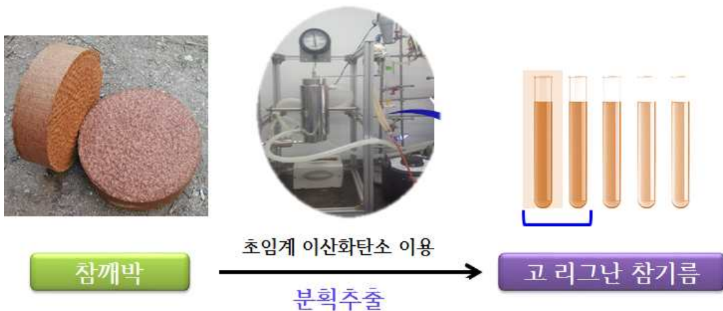
그림 4. 참깨박으로부터 초임계 이산화탄소 분획추출을 이용한 고 리그난 참기름 생산 과정
