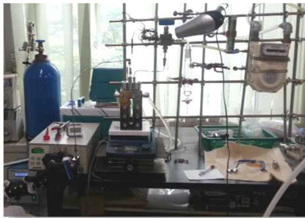
그림 12. 액체시료 전용 초임계 이산화탄소 추출 장치 (1차 리그난 농축물 생산을 위한 추출장치)
