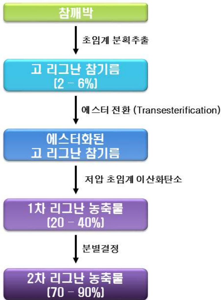
그림 7. 참깨박으로부터 고리그난 참기름 및 리그난 농축물 생산 과정
