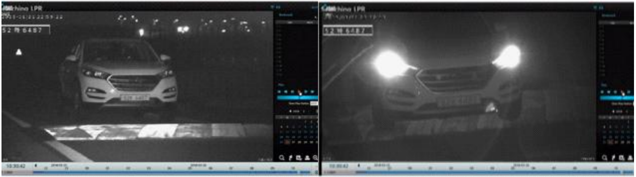
그림 98 번호판 인식 CCTV 야간 작동 성능 확인
