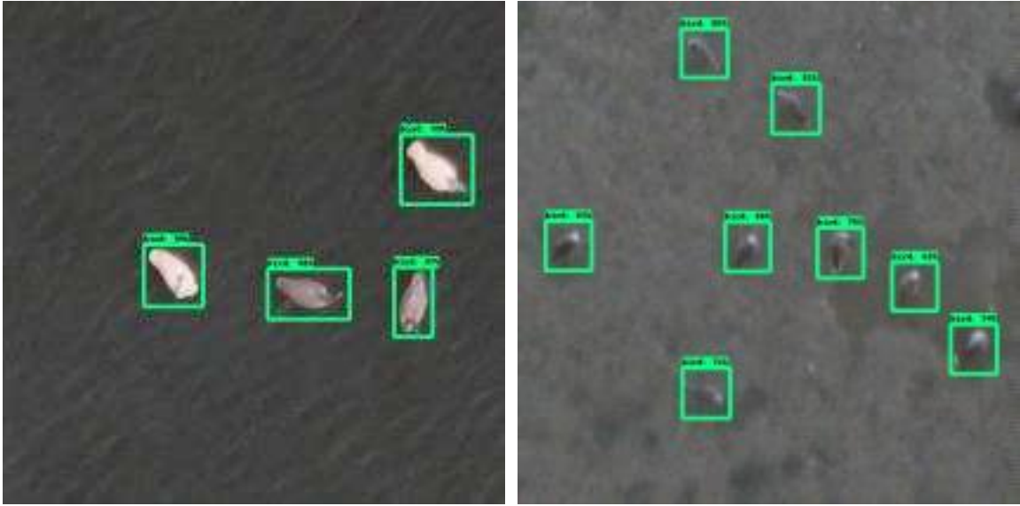
그림 116 Faster R-CNN Resnet 101 알고리즘을 이용한 야생조류 검출 영상
