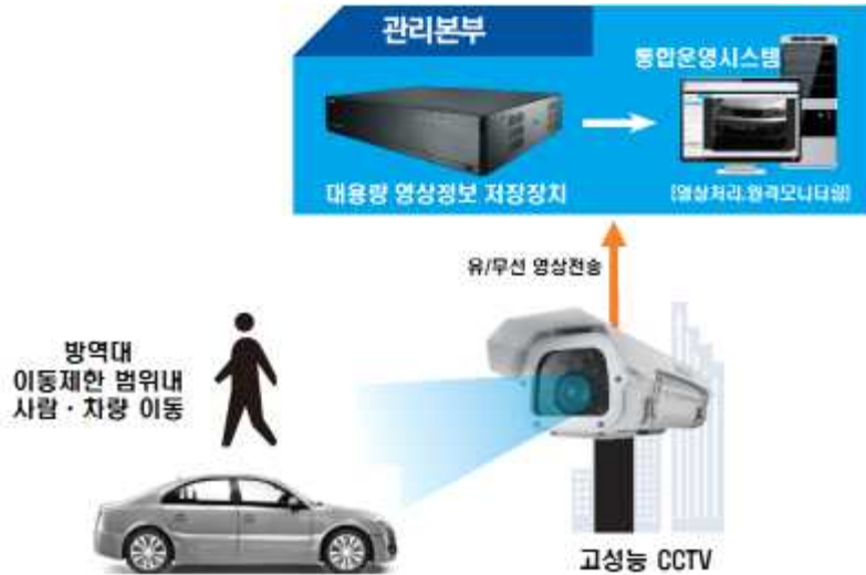
그림 91 고정식 CCTV를 이용한 방역대내 사람·차량 이동 식별시스템 구성 개념도
