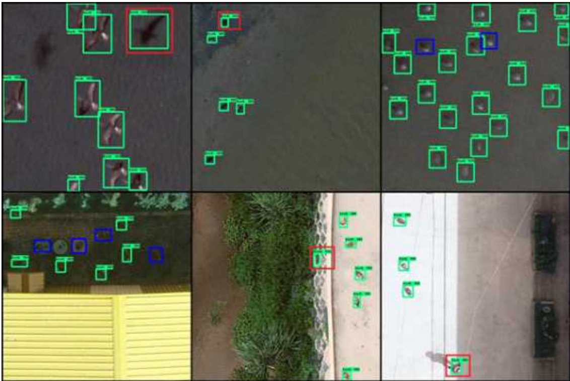
그림 118 Faster R-CNN 알고리즘을 이용한 철새검출 영상 (오검출 영상 포함)
