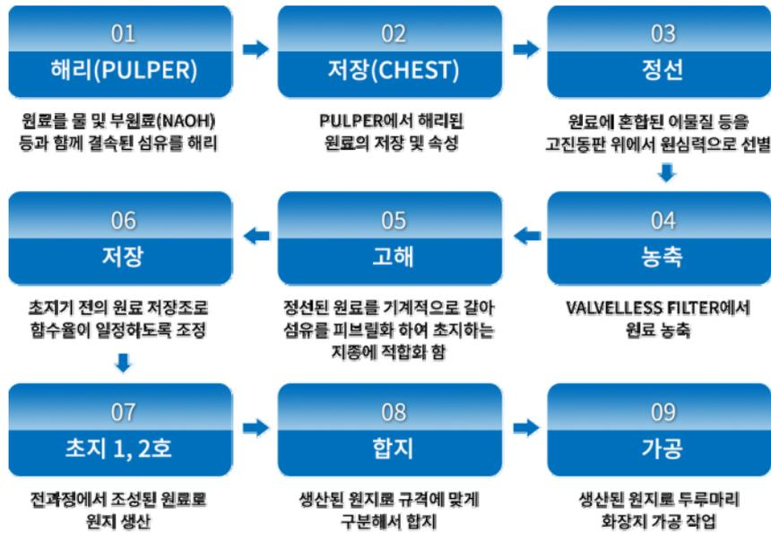
[그림 23] 화장지 및 키친타올 제조공정 모식도
