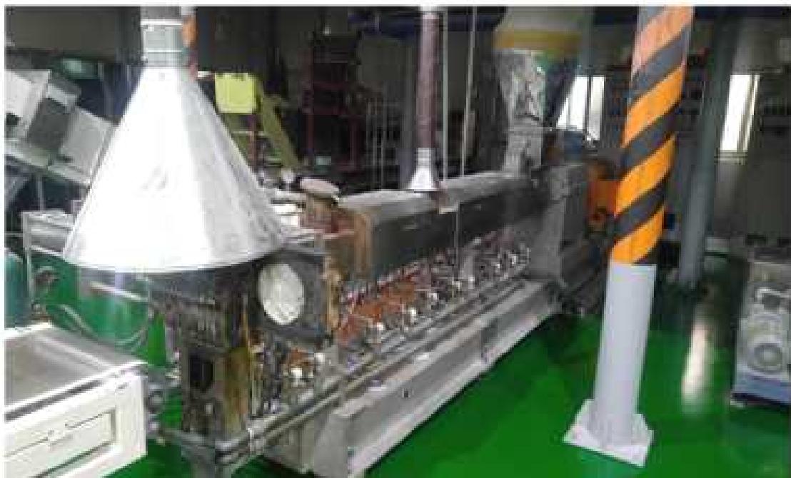
그림. 컴파운드 압출기를 이용한 ter-PP 및 마스터배치 / 발포바이오소재 제조 공정
