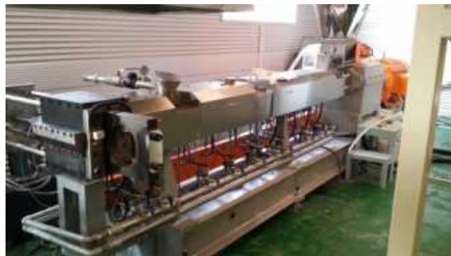
[그림]Extruder 메인 스크류 부분
