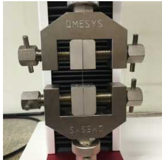
[그림] 인장강도 시편 측정
