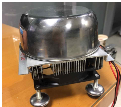
그림. 공냉방식의 72W 펠티어 냉각 장치
