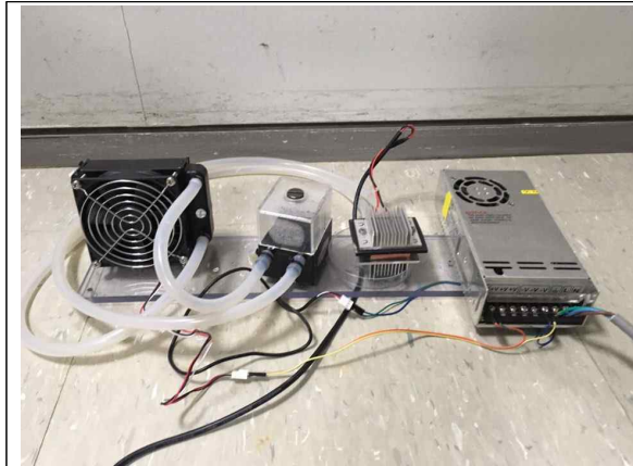
라이에이터와 수내에블터를 이용한 360W 냉각부 실험 구성
