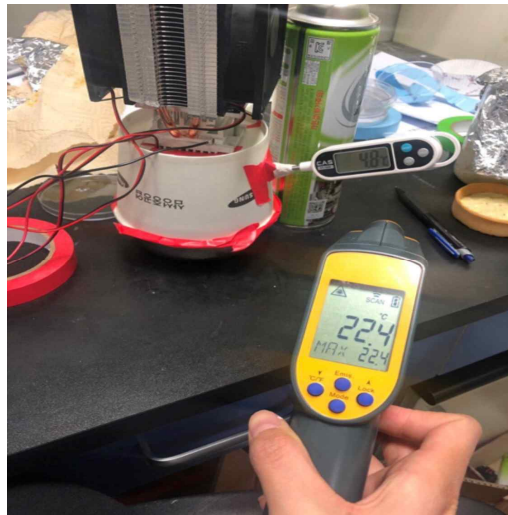
그림. 타워형 냉각장치를 이용하여 타르트를 냉각시키는 실험
