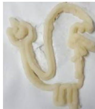
페이스트를 이용한 그림 토출 실험
