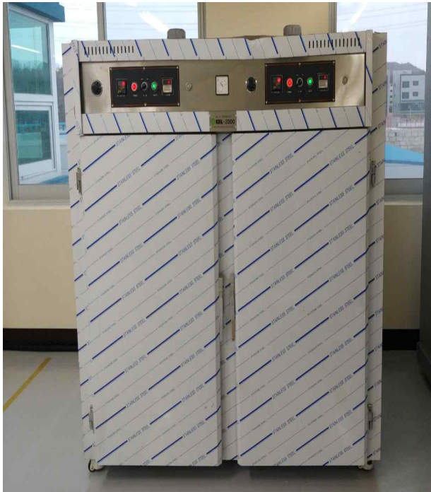
그림 14. 고온복합형열풍건조기 제작(20단형) 그림 15. 상부 조작기판
