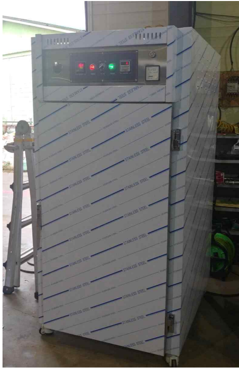
그림 13. 고온복합형열풍건조기 제작(10단형), 외부(좌)와 내부(우)
