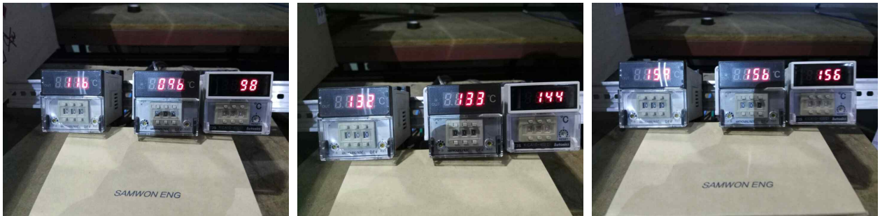
그림 6. 고온열풍건조장비를 이용한 내부 온도 테스트
