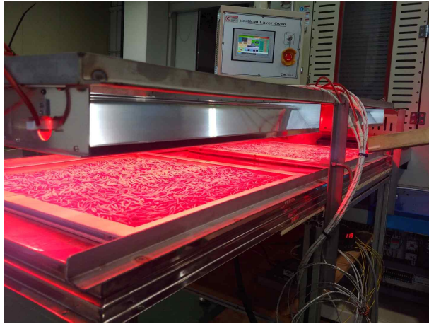
그림 41. 근적외선 램프를 이용한 가열장치
