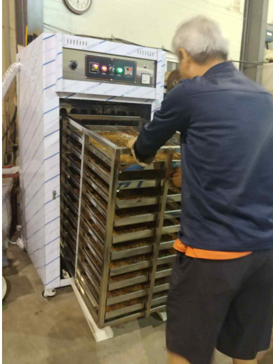
그림 20. 대차를 이용하여 건조기 빠른 투입
