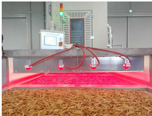
그림 42. 근적외선 가열장치를 통한 투입구 위치조정
