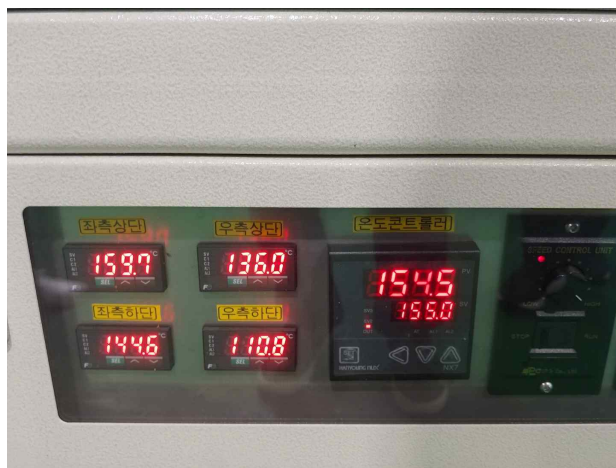
그림 44. 근적외선 컨베이어 사용 전(좌)과 후(우)의 내부온도
