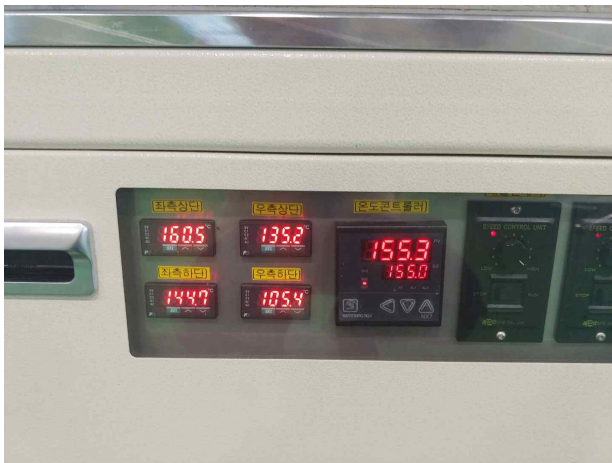
그림 34. 컨베이어 건조기 내부 온도표시
