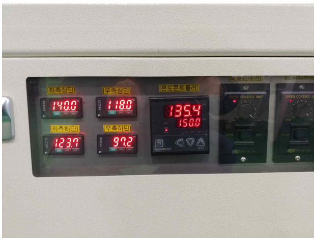
그림 44. 근적외선 컨베이어 사용 전(좌)과 후(우)의 내부온도
