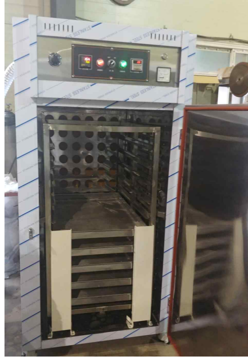
그림 13. 고온복합형열풍건조기 제작(10단형), 외부(좌)와 내부(우)
