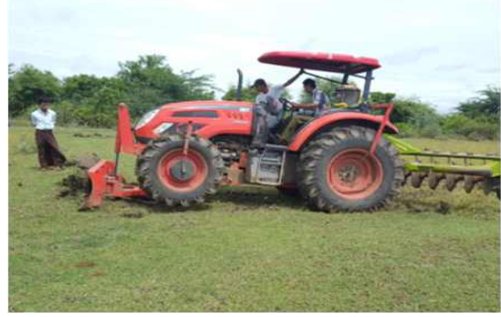
그림 4-6. 블레이드를 이용한 수목제거작업. 그림 4-7. 디스크헤로를 이용한 평탄작업.
