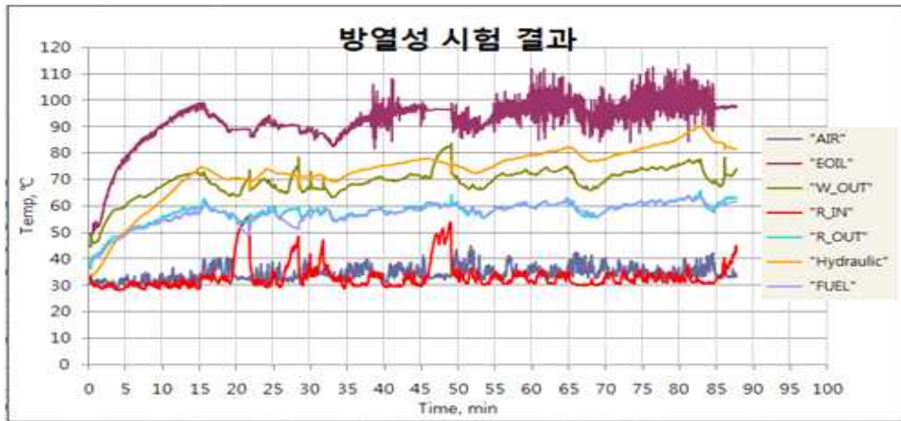
그림 4-21. 콤바인의 방열시험 결과.
