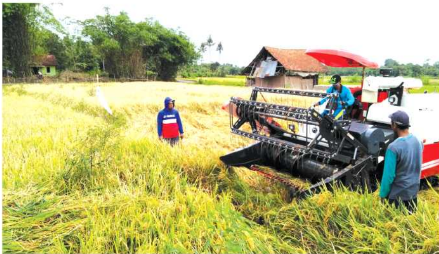
Tim penguji dari Fakultas Teknologi Pertanian UGM menunjukkan cara kerja mesin Combine Harvester Kioti DSF75 kepada para petani di Bulak Nglaren, Desa Potorono, Bantul, Rabu (28/11).
