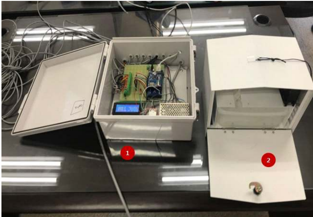
<그림> 범용 스마트팜 인터페이스 장치 - ① 아두이노 보드 ② 아날로그 온습도센서
