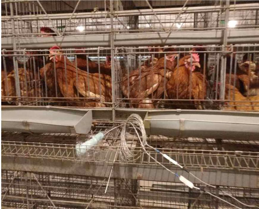
그림 2-4. THI 측정을 위한 건구온도 센서와 습구온도 센서.
