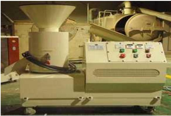
그림 10-1. 수평형 소형펠렛밀((die driving type).
