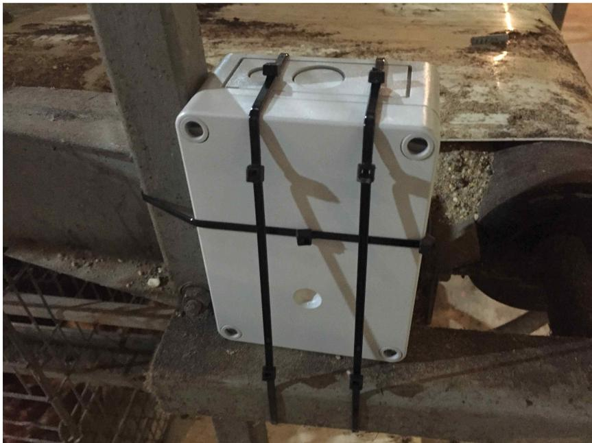
그림 1-3. 암모니아 가스 농도 측정 센서.
