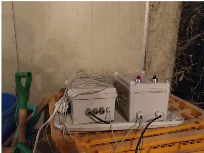
그림 2-5. THI를 측정한 후 전원 스위치 ON/OFF를 위한 장치.
