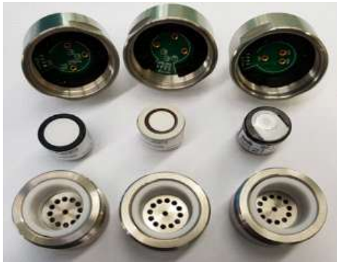
<그림 22> 메탈 디스크 필터 적용 센서 구조물
