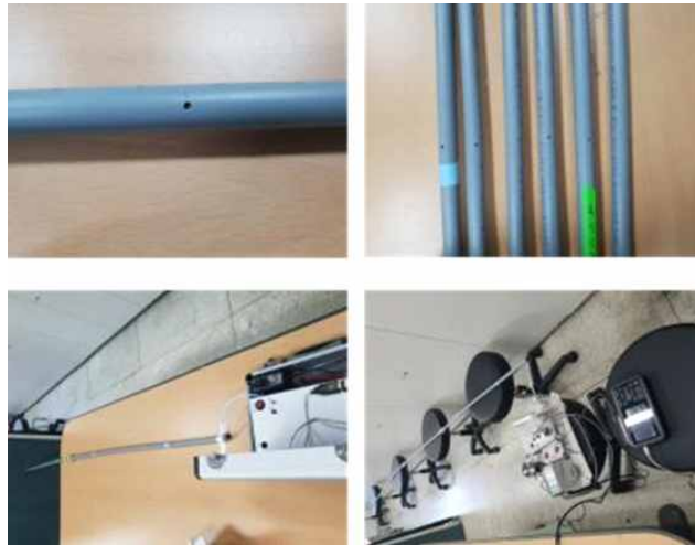
<그림 39> Area sampling port의 제작 사진
