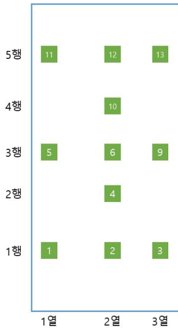
그림 3-2-2 대상 계사 내부 온습도 센서 설치 위치
