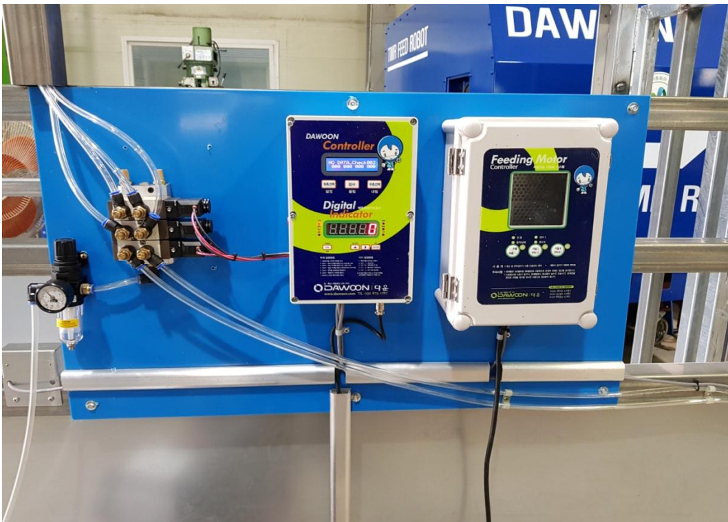
그림 96 전자저울 제어기 외부 프레임 및 제작 완료 상태
