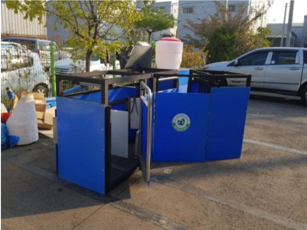
그림 123 양돈용 사료섭취량 조사기 시작품 완성 상태
