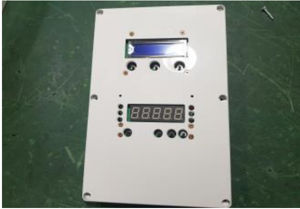
그림 131 전면부 가공 및 PCB배치
