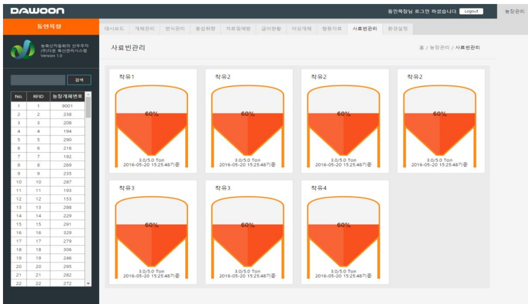
그림 242 농장에 설치운영중인 사료탱크의 사료 잔량
