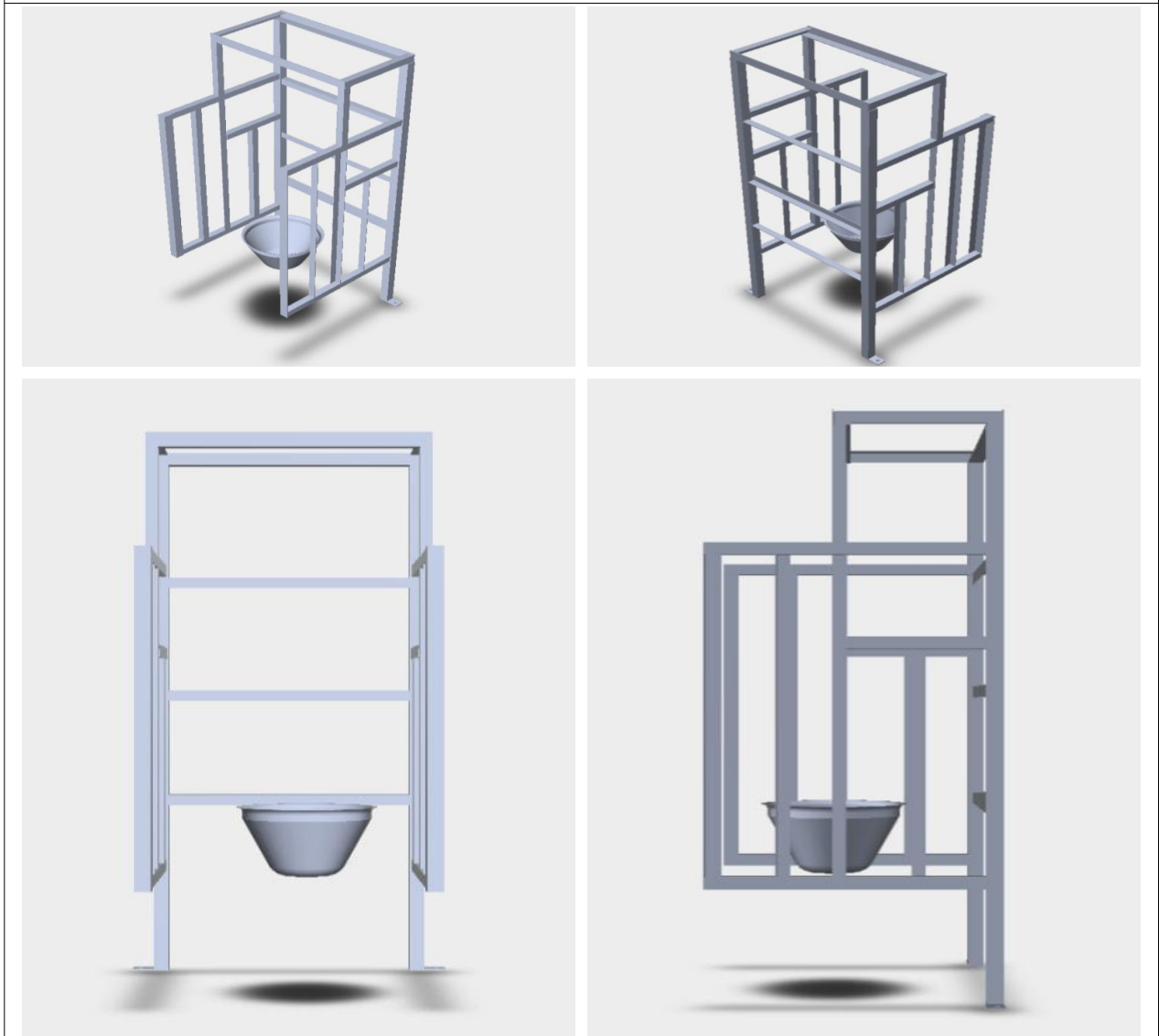
그림 151 전면부 프레임과 사료조 밥그릇의 위치 모식도
