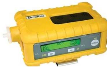
그림 2-3-4 실험 축사 내부 암모니아 및 이산화탄소 측정에 이용된 복합가스측정기 (MultiRAE IR, RAE system Inc., U.S.A.)
