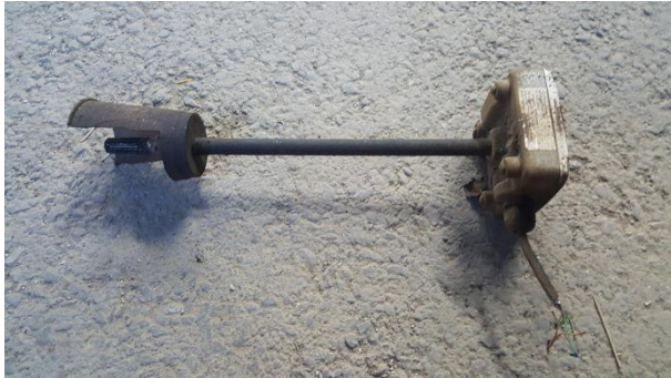
(a) 돈사 내부의 열악한 환경으로 인한 센서 덕짐
