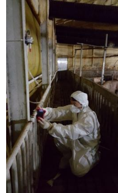
(d) 비육돈사 내부 가스 측정을 위한 기기 설치
