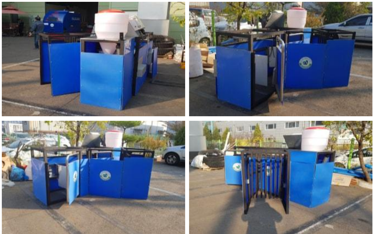
그림 122 양돈용 사료섭취량 조사기 시작품 제작
