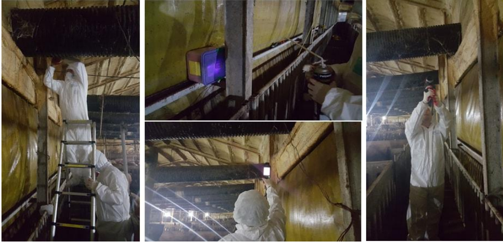
그림 3-5-17 덕트 내부 공기온도와 덕트 표면 온도 모니터링을 위한 실험 장치 설치 및 측정
