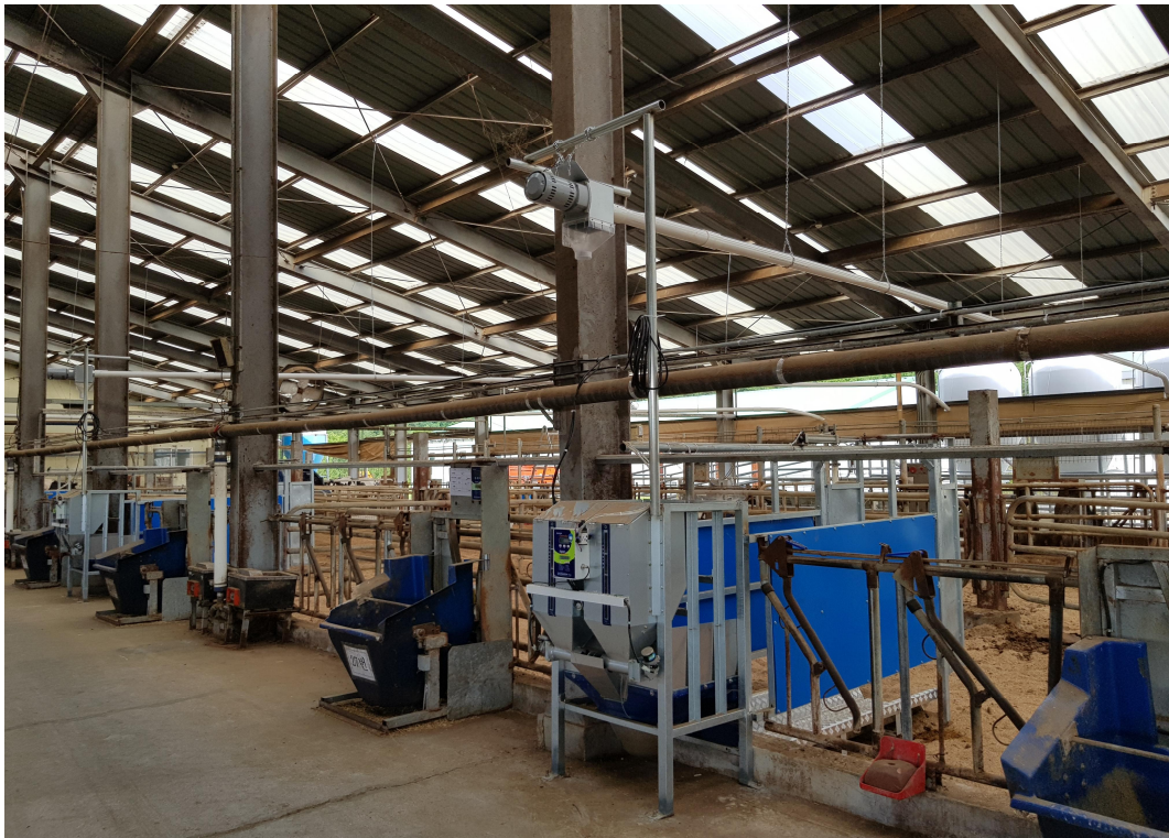
그림 217 한우용 사료섭취량 조사기 및 자동사료 급여기 설치 운영
