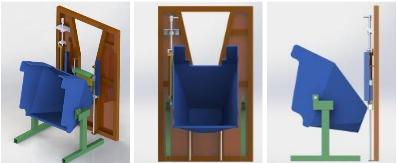
그림 55 섬취량 조사기 배치도 (섬취조 회전 및 청소준비 상태)
