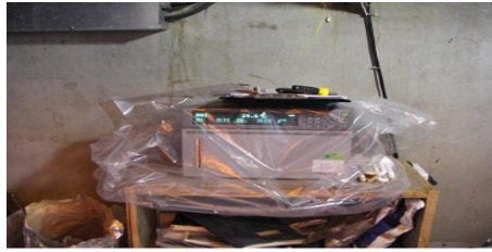
그림 2-5-10 홍성 농장에 설치한 다채널 데이터 수집 장치 (DC100)
