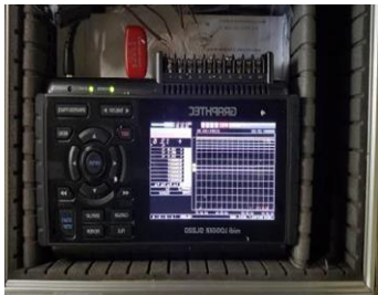
벽체온도 모니터링 데이터로거 (GRAPHTEC Inc., USA)
