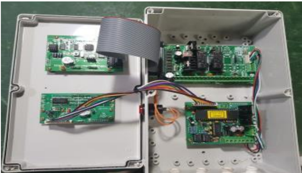
그림 124 섭취량 조사시스템 주제어장치
