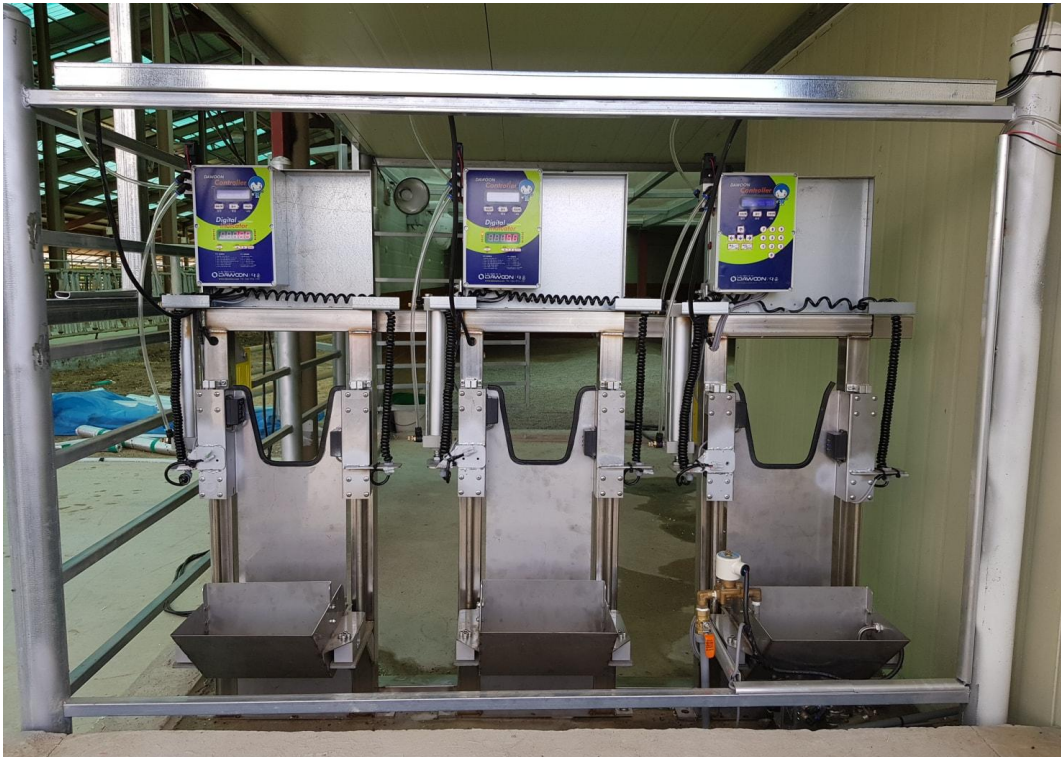
그림 75 음수량 조사기(송아지용) 실제작품 제작
