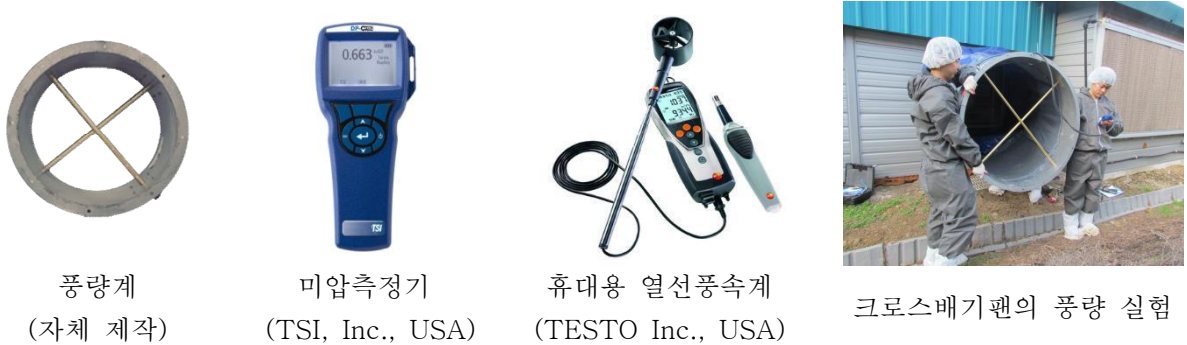
그림 2-5-13 측벽 크로스배기팬의 풍량 실험을 위한 기기 및 현장 실험
