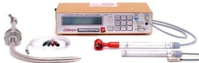
그림 2-3-6 축산시설 내부 분진 측정을 위한 휴대용 측정기 [Aerosol spectrometer (Grimm Inc., Germany)]
