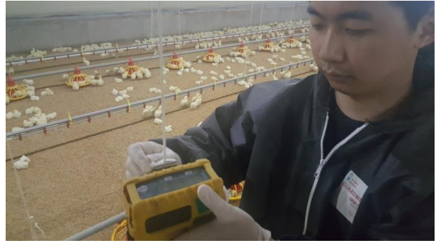
(b) 육계사 내 가스 측정을 위한 기기 설치
