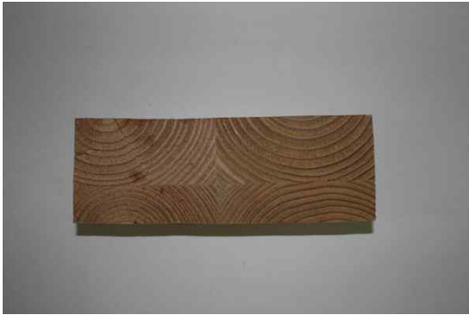
그림 A1-28 낙엽송 접합부재 시험편
