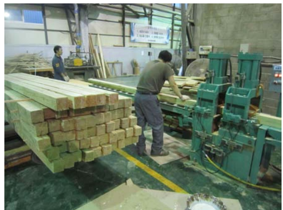
그림 A2-44 핑거조인트 품질 향상을 위한 수평절삭 및 수동 작업
