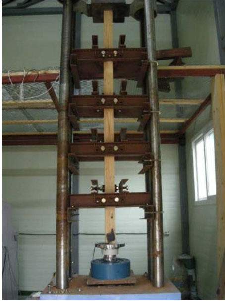
그림 B1-1 소경각재 실대재의 압축시험 그림 B1-2 다중접착접합 기둥 부재의 압축시험
