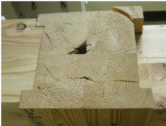
그림 B2-53 PI-C-T-S 접합부의 파괴
