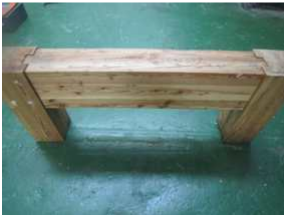
그림 B2-57 SB-G-T-S 접합부의 파괴
