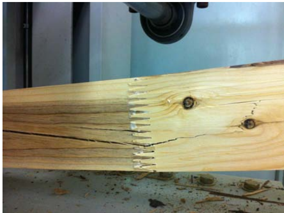
그림 B2-33 핑거조인트에서 시작된 파괴가 섬유경사를 따라서 진행
