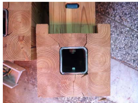
그림 B2-67 TB-F-T-S 접합부에서 전단하중에 의한 기둥의 갈라짐
