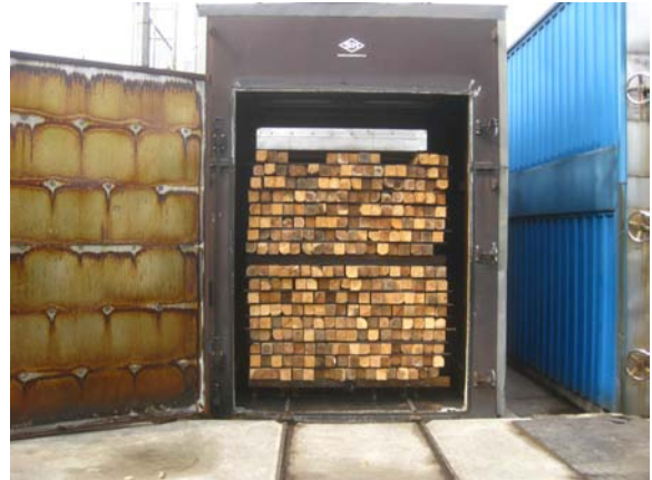
그림 A2-45 잣나무 소경각재의 건조를 위한 잔적 및 건조로 내부 투입
