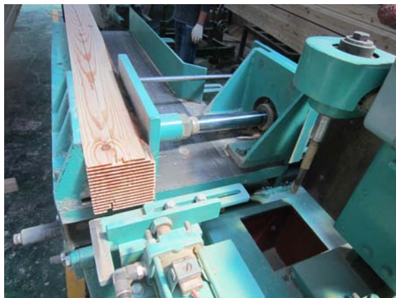
그림 A2-44 핑거조인트 품질 향상을 위한 수평절삭 및 수동 작업
