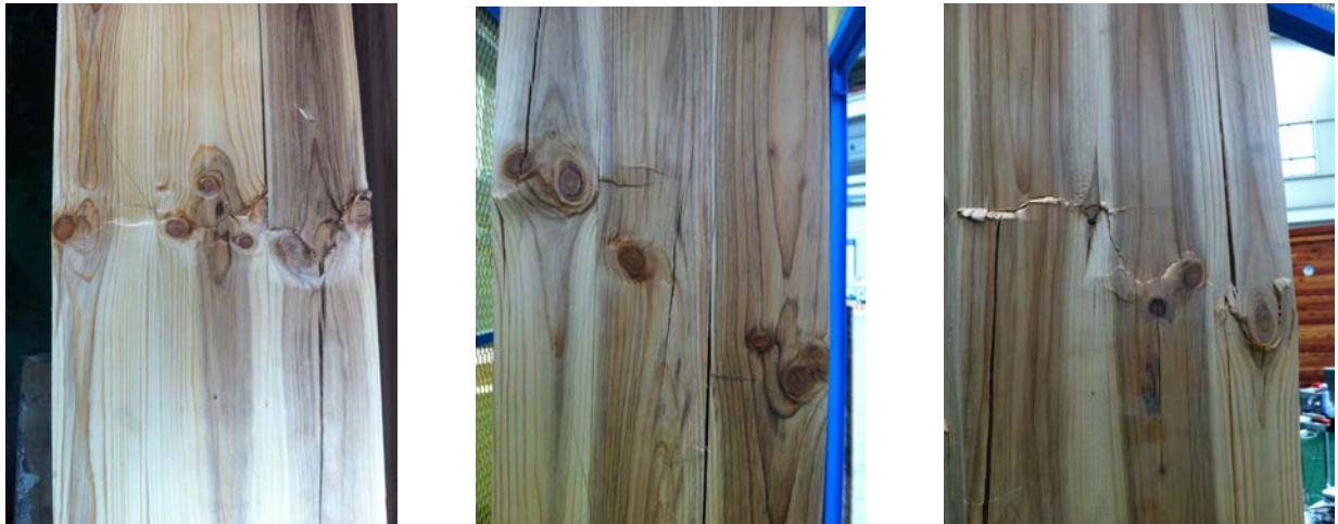
그림 B2-37 모인 용이 주변에서의 압축과괴
