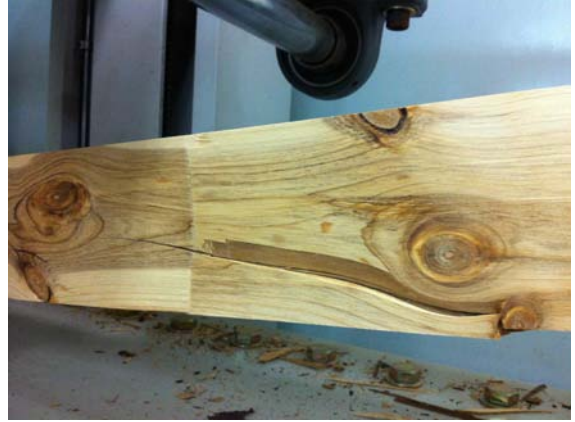
그림 B2-32 결점에서 시작된 파괴가 핑거조인트 쪽으로 진행
