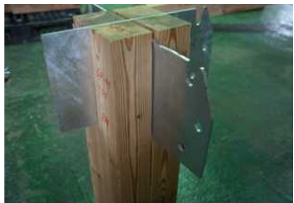
그림 B2-58 SC-C-N-S 접합부의 파괴
