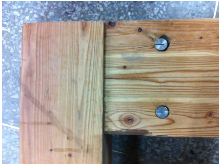
그림 B2-65 회전모멘트에 의한 접합부 고정핀의 변형
