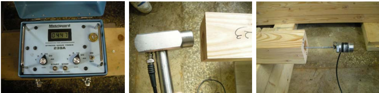
(A) 콘크롤 박스 (B) 초음파 센서가 내장된 망치 (C) 초음파 감지 센서
