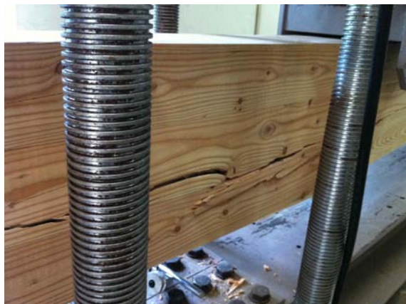
그림 B1-72 중립축 부근에서의 전단파괴
