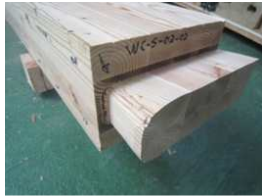
그림 B2-62 WC-N-T-S 접합부의 파괴
