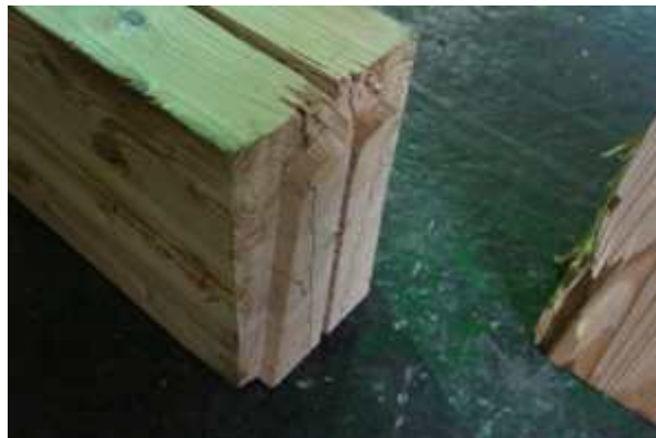
그림 2-59 SC-C-T-S 접합부에서 장부의 압축변형
