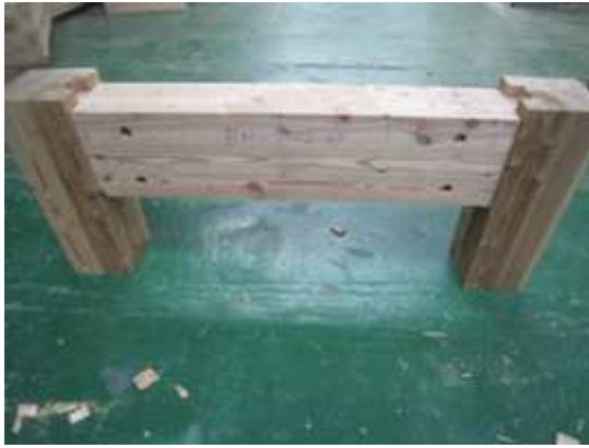
그림 B2-54 전단하중 하에서 BN-C-T-S 접합부의 변형 및 기둥의 파괴
