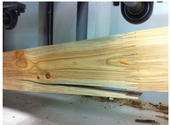
그림 B2-33 핑거조인트에서 시작된 파괴가 섬유경사를 따라서 진행
