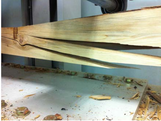
그림 B2-26 용이와 상관없이 섬유경사를 따라서 발생한 파괴
