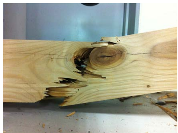
그림 B2-25 큰 웅이 주변의 섬유경사를 따라서 발생한 파괴
