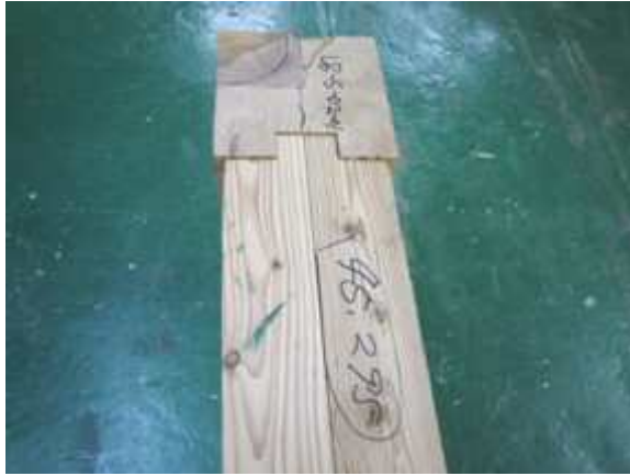
그림 B2-56 LB-F-T-S 접합부의 파괴
