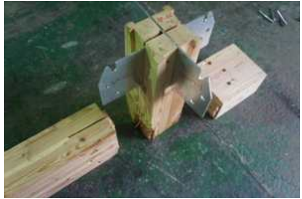
그림 B2-58 SC-C-T-S 접합부의 파괴
