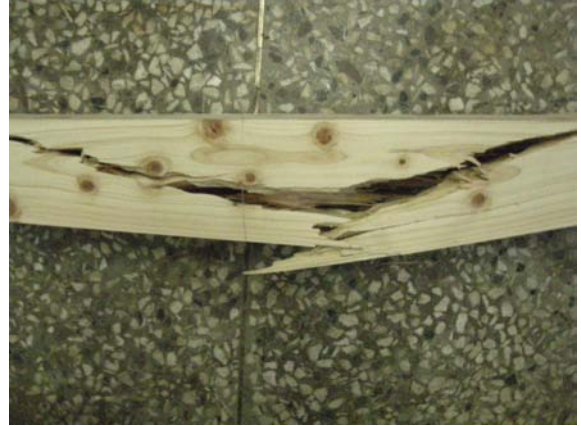
그림 B1-29 섬유경사를 따라서 발생한 파괴
