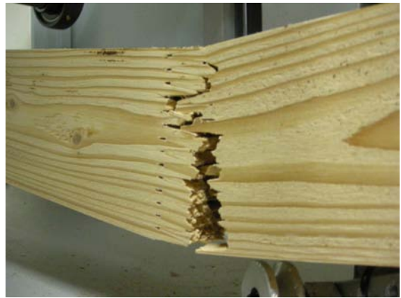
그림 B1-41 핑거의 인장응력에 의한 부러짐
