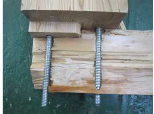
그림 B2-56 LB-F-T-S 접합부의 파괴
