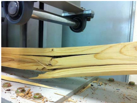
그림 B2-27 휨응력(인장)과 전단에 의한 파괴
