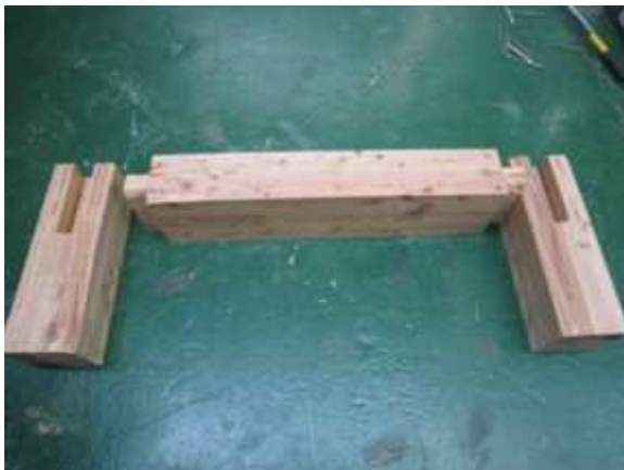
그림 A2-40 전통주먹장맞춤접합부의 구성
