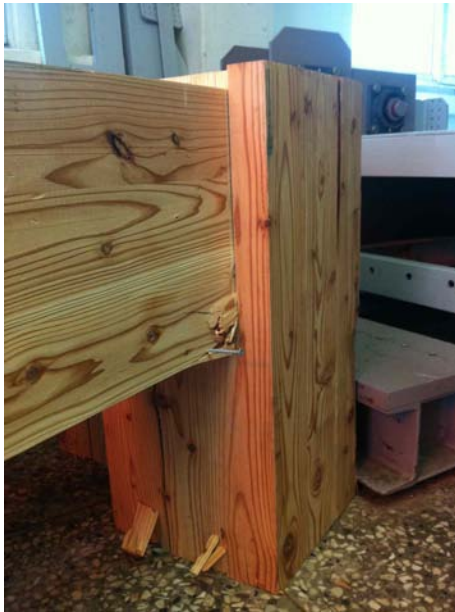
그림 B2-66 TB-F-T-S 접합부에서 전단하중에 의한 보의 처짐
