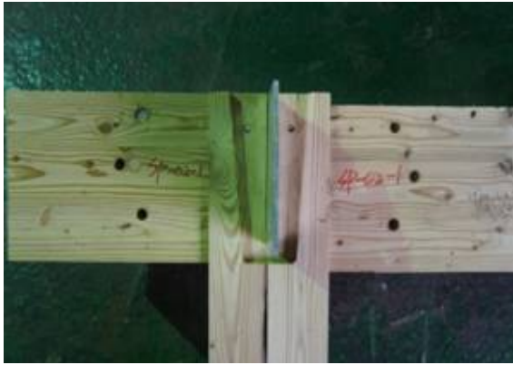
그림 B2-58 SC-C-T-S 접합부의 파괴
