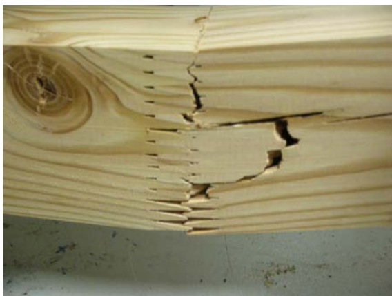
그림 B1-42 핑거의 인장 및 전단에 의한 파괴
