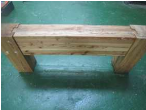
그림 A2-23 완성된 철근접착 접합부
