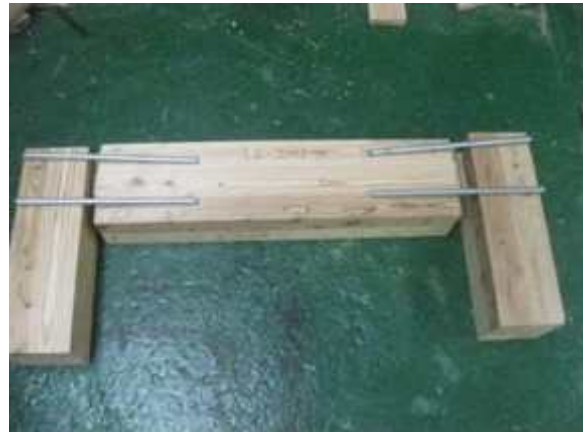
그림 A2-14 래그볼트 접합부의 구성
