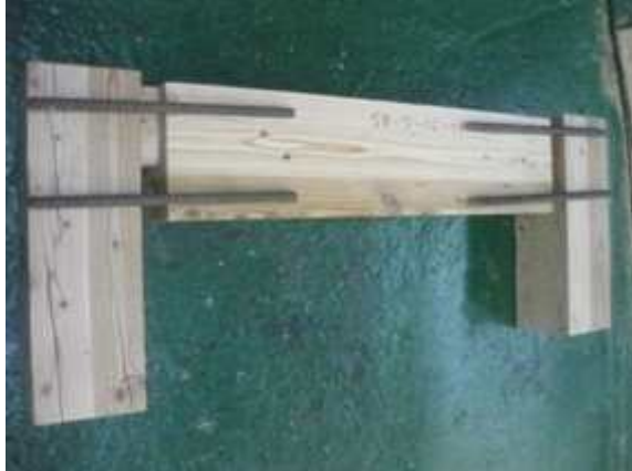
그림 A2-21 철근접착 접합부의 구성부분
