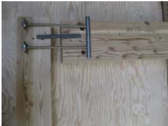
그림 A2-11 회전모멘트 저항 볼트-너트 접합부의 구성
