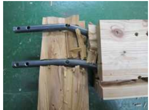
그림 B2-53 PI-C-T-S 접합부의 파괴
