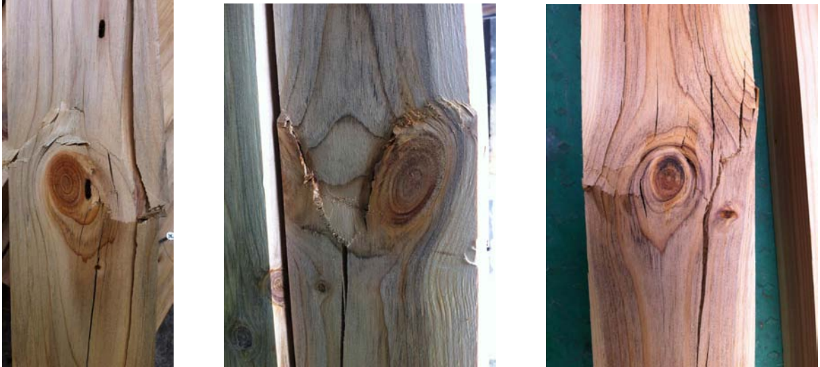
그림 B2-17 잣나무 소경각재에서 나타나는 큰 옹이 주변에서의 파괴
