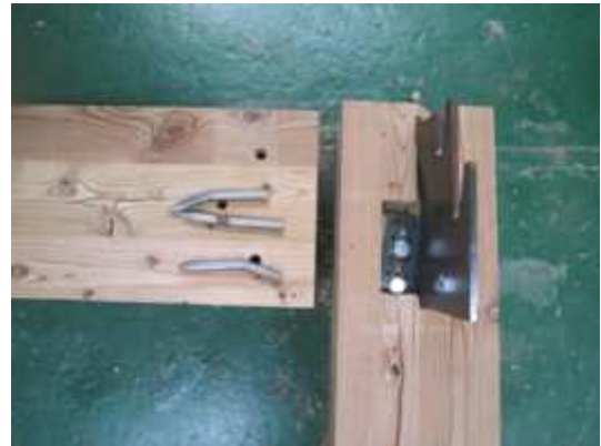
그림 B2-61 SE-C-N-S 접합부의 파괴
