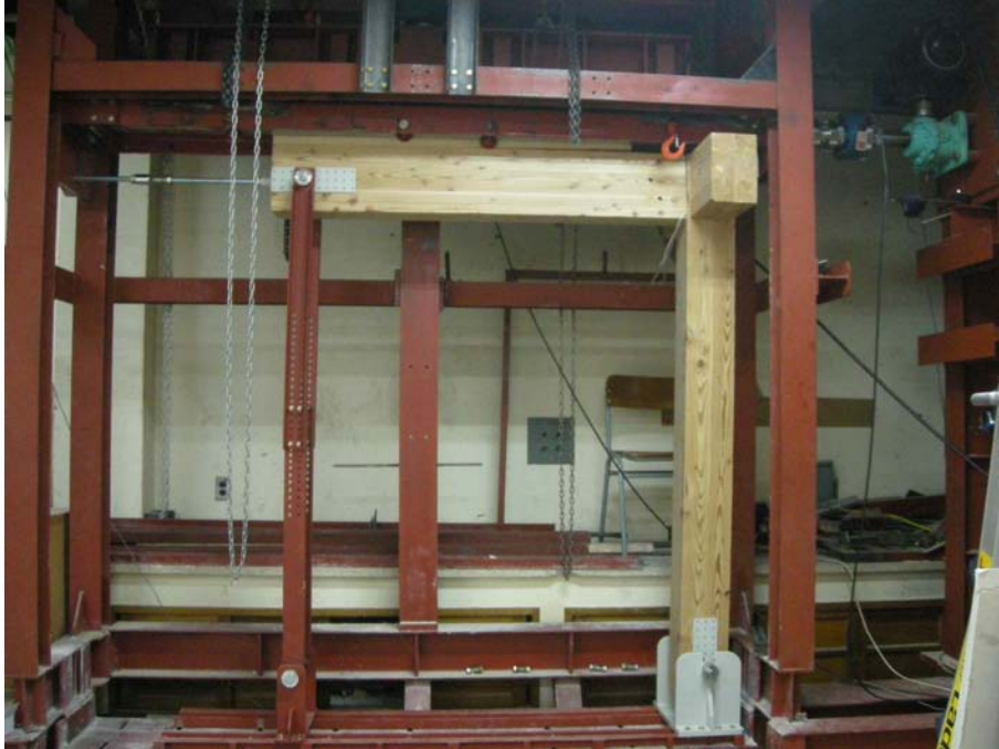
그림 B2-63 접합부의 회전모멘트 저항 시험
