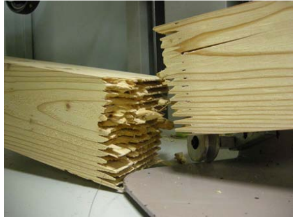
그림 B1-44 인장응력에 의한 핑거의 부러짐 그림 B1-45 접착층의 분리에 의한 핑거의 빠짐
