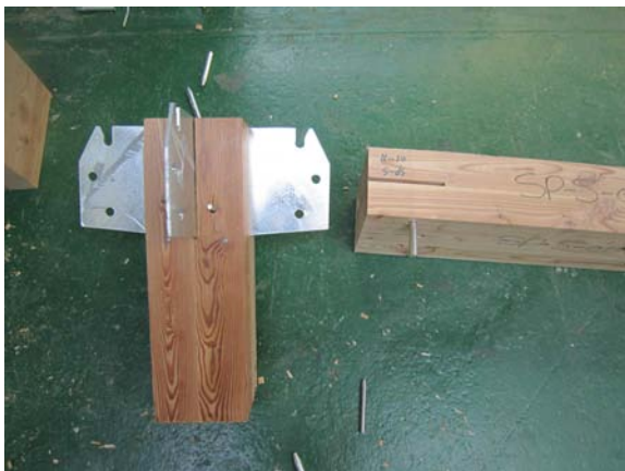
그림 A2-26 십자철관 접합부의 구성
