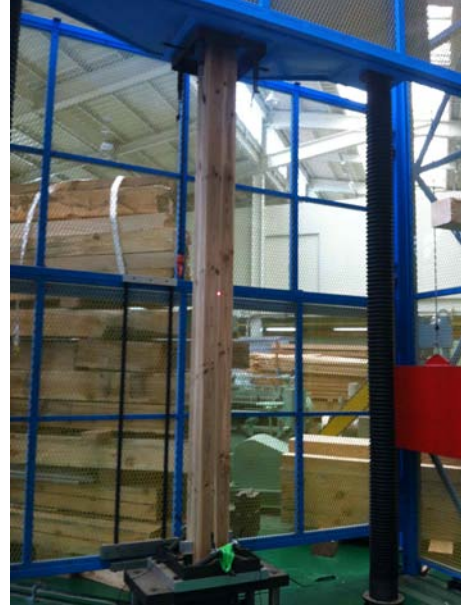
그림 B2-4 다중접착접합 기둥 부재의 압축시험
