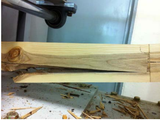
그림 B2-32 결점에서 시작된 파괴가 핑거조인트 쪽으로 진행
