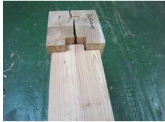
그림 B2-54 전단하중 하에서 BN-C-T-S 접합부의 변형 및 기둥의 파괴
