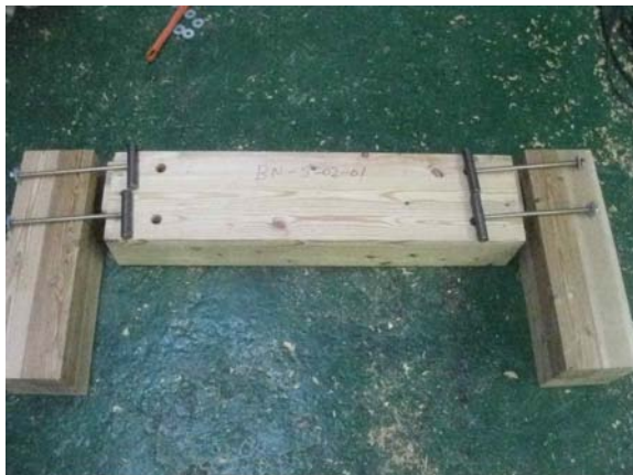
그림 A2-7 볼트-너트 접합부의 구성
