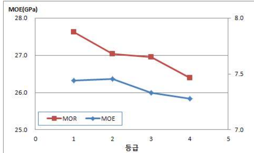
그림 B2-28 핑거조인트 잣나무 소경각재의 휨 시험 결과
