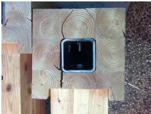
그림 B2-67 TB-F-T-S 접합부에서 전단하중에 의한 기둥의 갈라짐
