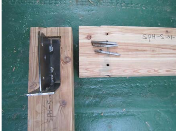
그림 A2-34 안장철판 접합부의 구성
