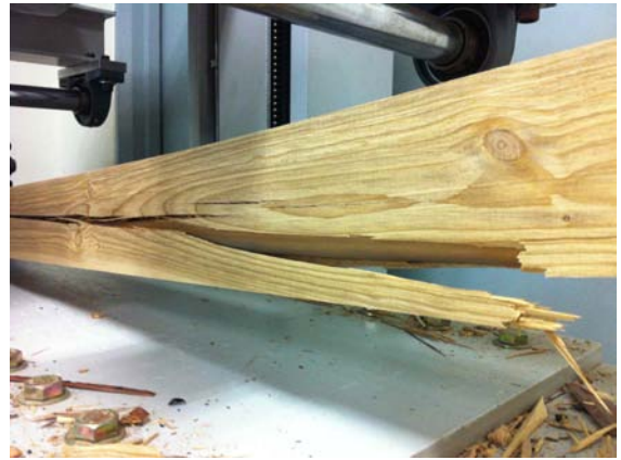
그림 B2-26 용이와 상관없이 섬유경사를 따라서 발생한 파괴
