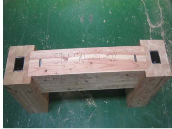
그림 A2-42-1 각형강관접합맞춤접합부의구성 그림 A2-42-2 완성된각형강관접합부시험편
