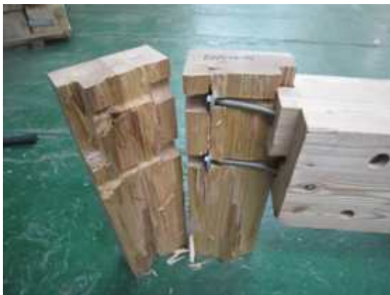
그림 B2-55 BN-C-T-S 접합부 내부의 철물의 변형
