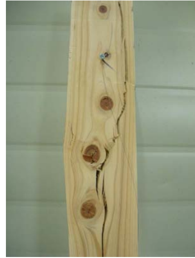
그림 B1-17 낙엽송에서 용이 주변의 파괴 그림 B1-18 낙엽송에서 모인 용이 주변의 파괴
