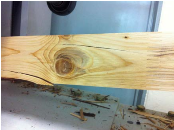
그림 B2-31 핑거조인트 이외의 결점에 의한 파괴
