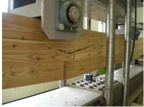
그림 B1-67 핑거 탈락 후 경사 전단 파괴
