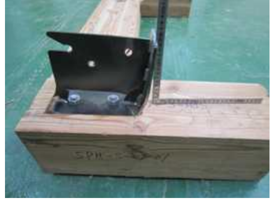
그림 B2-60 SH-C-N-S 접합부의 파괴
