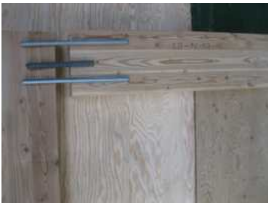
그림 A2-18 래그볼트 접합부의 구성
