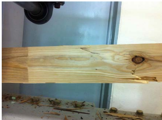
그림 B2-31 핑거조인트 이외의 결점에 의한 파괴
