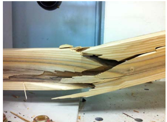
그림 B2-27 휨응력(인장)과 전단에 의한 파괴
