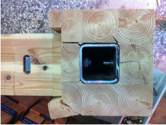
그림 B2-68 TB-F-T-S 접합부에서 전단하중에 의한 기둥의 갈라짐
