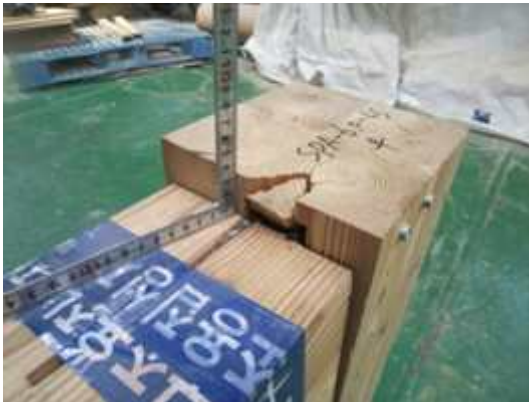
그림 B2-61 SE-C-N-S 접합부의 파괴
