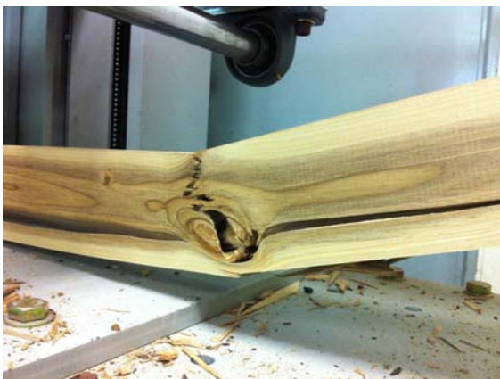
그림 B2-25 큰 웅이 주변의 섬유경사를 따라서 발생한 파괴
