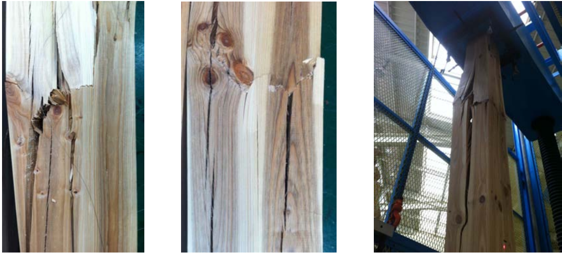
그림 B2-36 180mmx180mm 부재에서 모인 용이 주변에서의 압축과괴 후 기둥의 길이방향으로 갈라짐
