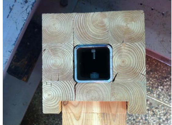
그림 B2-68 TB-F-T-S 접합부에서 전단하중에 의한 기둥의 갈라짐
