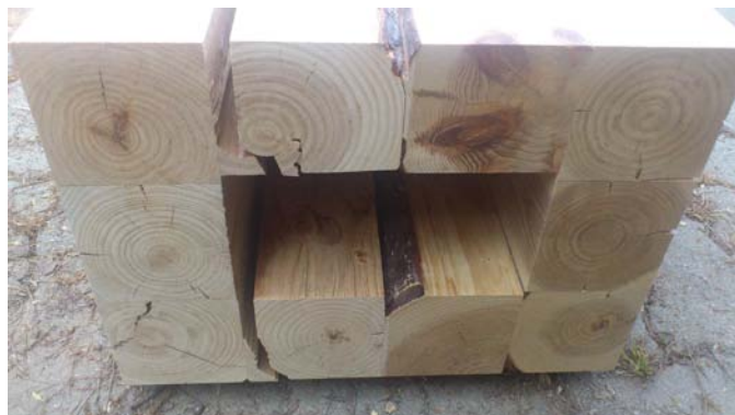
그림 B2-41 수평 및 수직 접착층의 파괴
