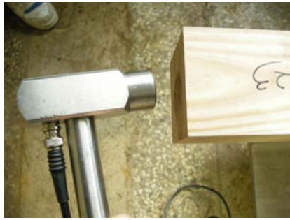
(A) 콘크롤 박스 (B) 초음파 센서가 내장된 망치 (C) 초음파 감지 센서
