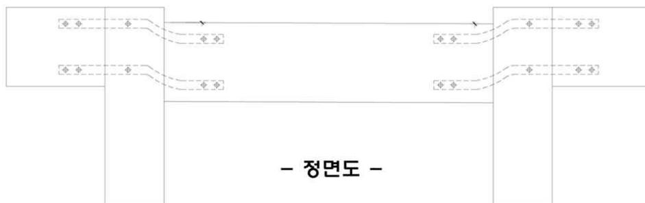
그림 A2-3 PI-C-N-S 접합부의 전단변형
