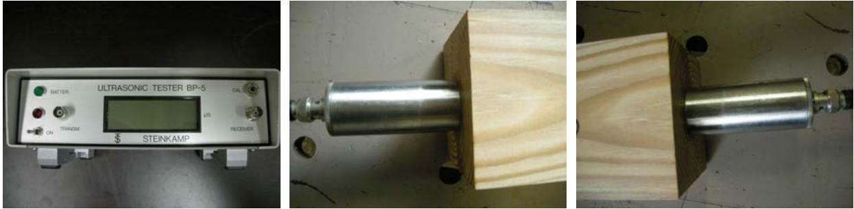
(A) 콘트롤 박스 (B) 초음파 전달 센서 (C) 초음파 감지 센서
