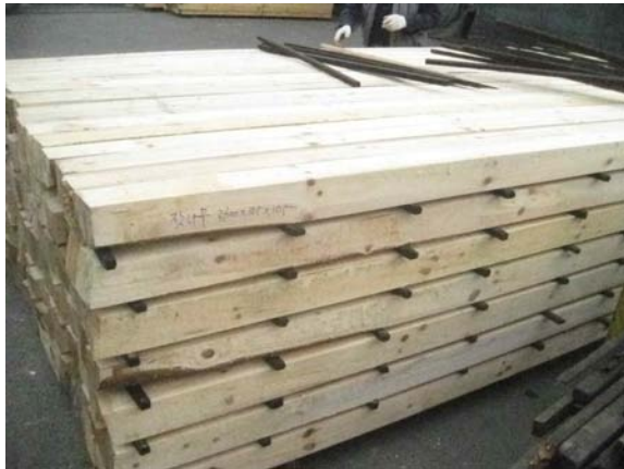
그림 A2-45 잣나무 소경각재의 건조를 위한 잔적 및 건조로 내부 투입
