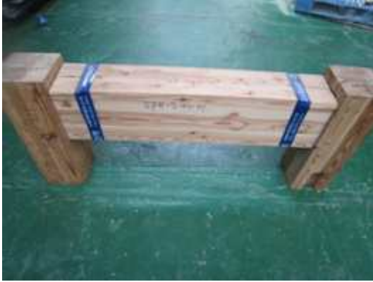
그림 B2-60 SH-C-N-S 접합부의 파괴
