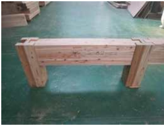
그림 B2-62 WC-N-T-S 접합부의 파괴
