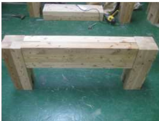
그림 A2-36 반이철판 접합부의 구성
