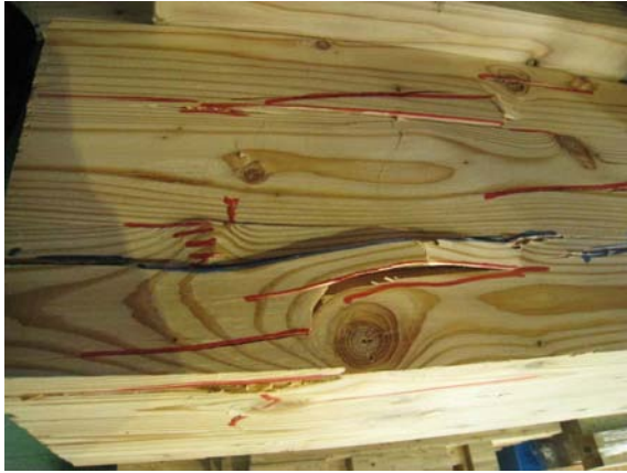
그림 B1-56 모인 용이 주변에서의 파괴
