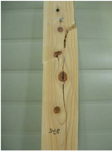
그림 B1-17 낙엽송에서 용이 주변의 파괴 그림 B1-18 낙엽송에서 모인 용이 주변의 파괴
