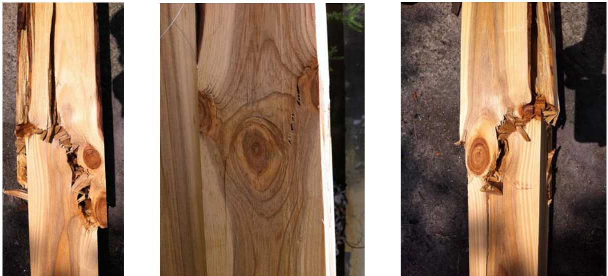
그림 B2-18 잣나무 소경각재에서 나타나는 모인 옹이 주변의 파괴
