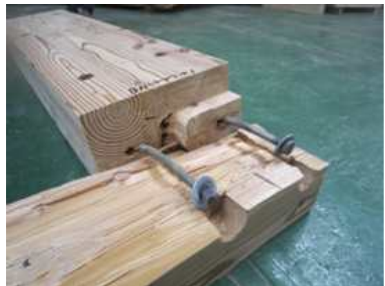
그림 B2-55 BN-C-T-S 접합부 내부의 철물의 변형
