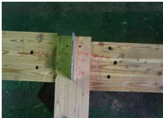
그림 B2-58 SC-C-N-S 접합부의 파괴
