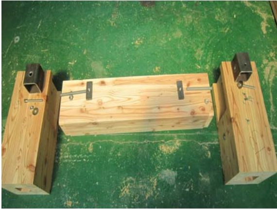
그림 A2-42-1 각형강관접합맞춤접합부의구성 그림 A2-42-2 완성된각형강관접합부시험편
