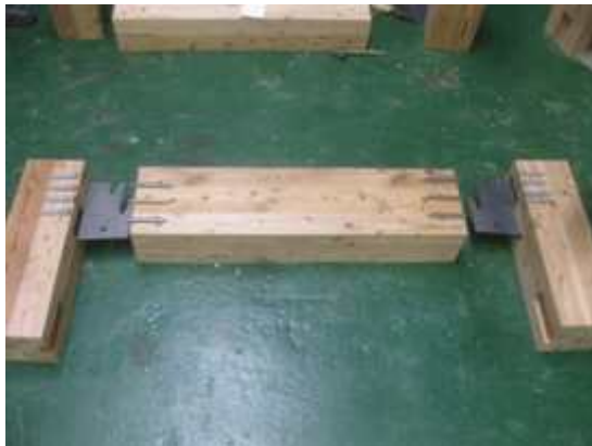
그림 A2-36 반이철판 접합부의 구성
