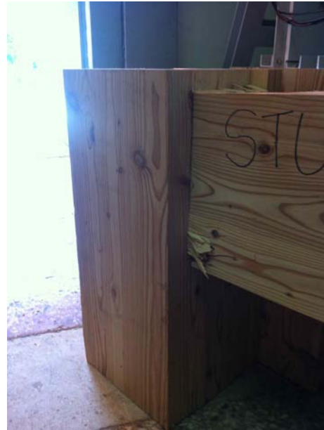
그림 B2-66 TB-F-T-S 접합부에서 전단하중에 의한 보의 처짐
