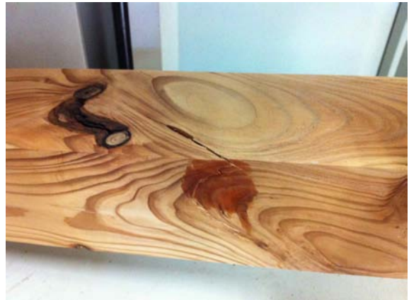
그림 B1-47 꺾질박이 및 섬유경사를 따라 파괴
