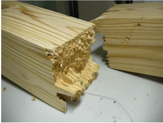
그림 B1-44 인장응력에 의한 핑거의 부러짐 그림 B1-45 접착층의 분리에 의한 핑거의 빠짐
