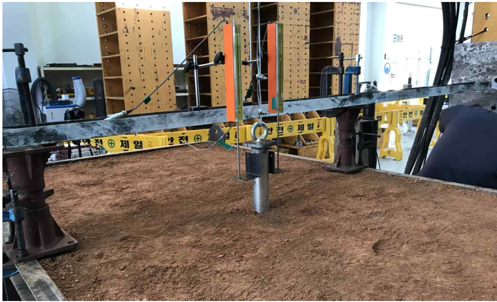
[2-4] 그림 94. 기초 인발성능 실험체 설치상황
