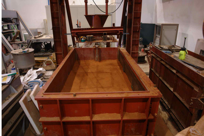
[2-4] 그림 37. 토조 단면도 및 실 사진
