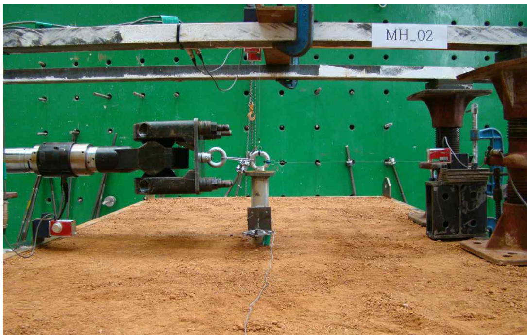
[2-4] 그림 98. 기초 수평저항성능 실험체 설치상황
