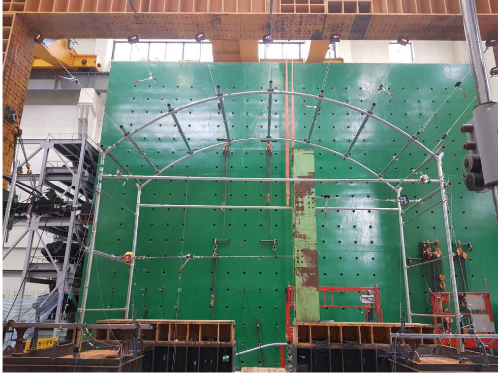
[2-4] 그림 122. 풍하중 저항성능실험 최대하중시 변형형상
