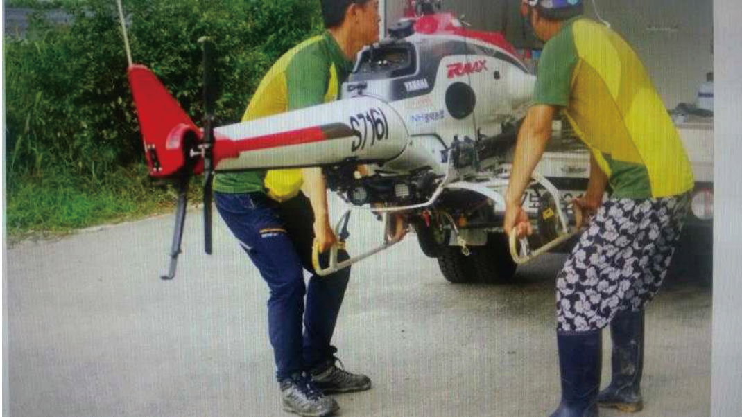
그림 5 약 80kg 기체를 하루에 수 십 차례 인력수동으로 상/하차하는 현장
