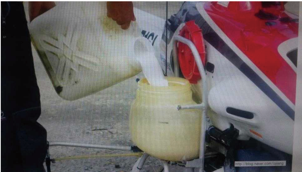
그림 8 충전장치 부재로 고농축 농약을 보호장구 없이 플라스틱 통으로 충전
