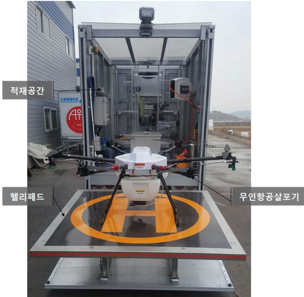
그림 59 헬리패드에 드론을 탑재한 모습
