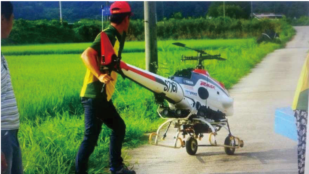
그림 6 트럭 적재공간이 부족하여 메인로터(프로펠러)를 탈거 한 상태로 수송이륙 장애물(수풀 등)이 없는 발착지를 선정 이륙장소로 조종사가 밀어서 이동
