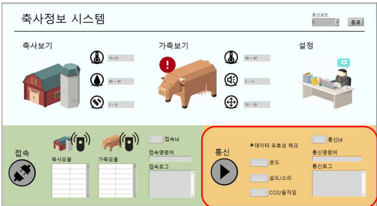
그림. LoRa 무선 통신 장치와 접속 후 각 노드센서와 통신이 이루어지는 과정이 나오는 UI
