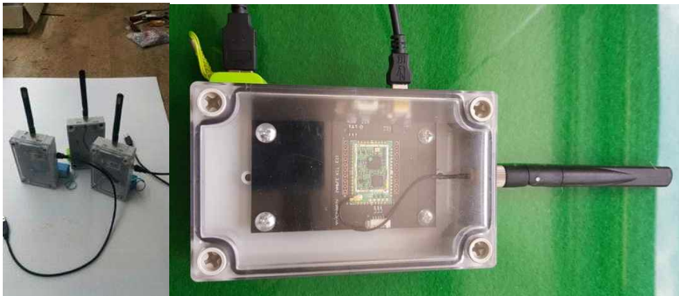
그림. 마이크로 프로세서를 이용한 가속 모니터링 보드 시험품 제작
