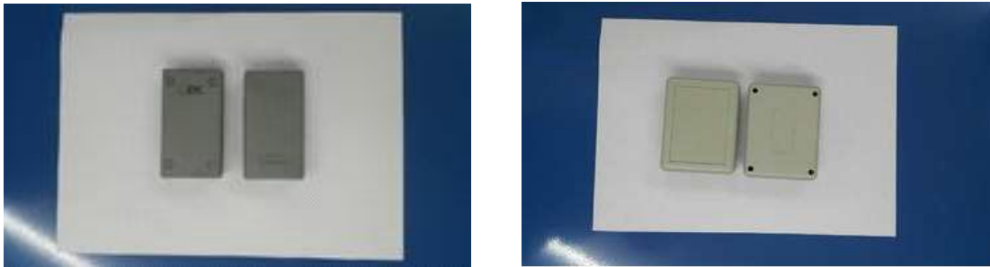
그림. LoRa 모듈장치의 개발초기와 개발이후 (약 20% 크기감소)
