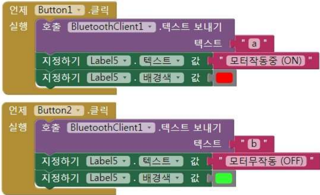
그림 116. 휴대폰으로 수동으로 모터를 작동시키기 위한 프로그램
