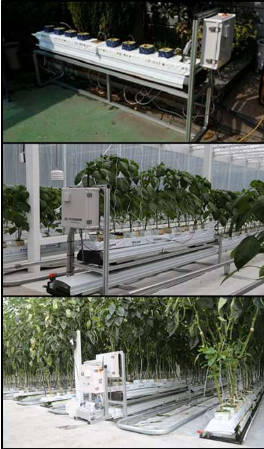
<2미터 길이 무게(중량)센서 및 수분센서 데이터 수집 장치>
