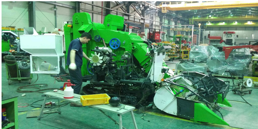
-배출부 조립 및 배선연결-
