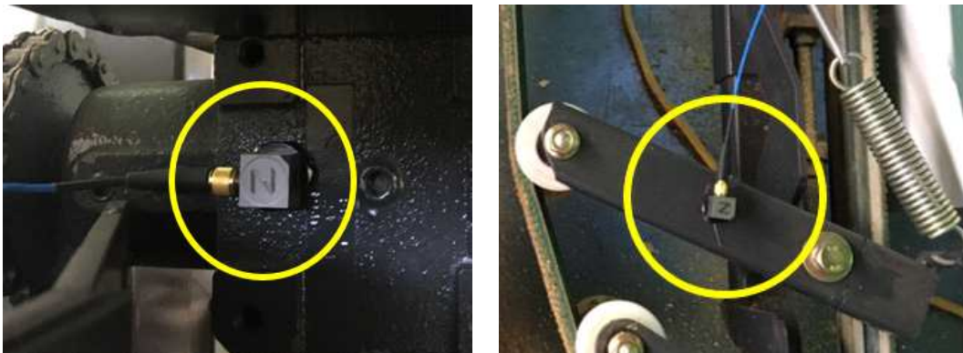
그림 93. 진동센서 부착위치(동력전달부(좌), 협지이송부(우))
