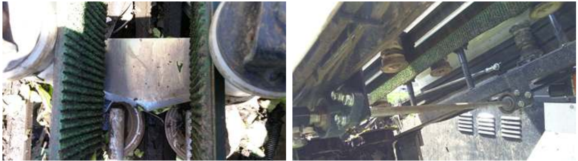
그림 6. 뿌리 절단칼날(좌), 전동실린더 및 링크 구조(우)
