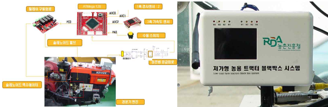
그림 48. 경운기 엔진 긴급정지장치(좌), 트랙터용 블랙박스(우)
