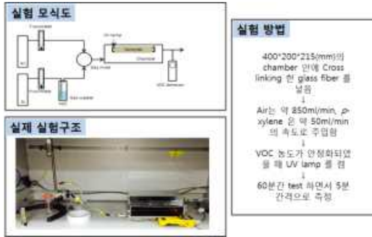
[그림 3-22] 유해성 기체 제거 효율 평가 시스템
