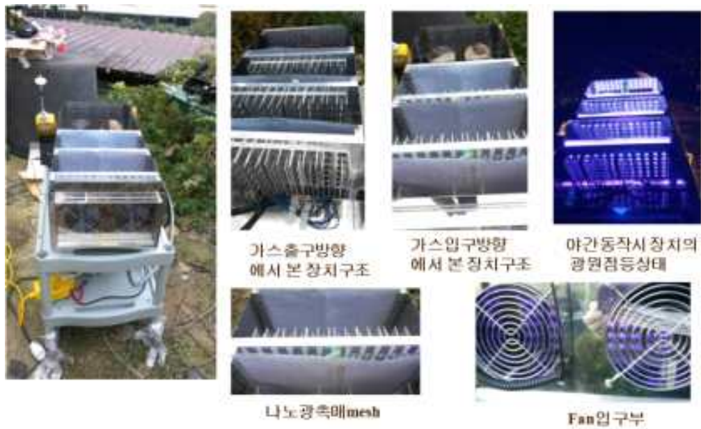
[그림 3-122] 능동형 나노광촉매 악취저감장치 동작시험
