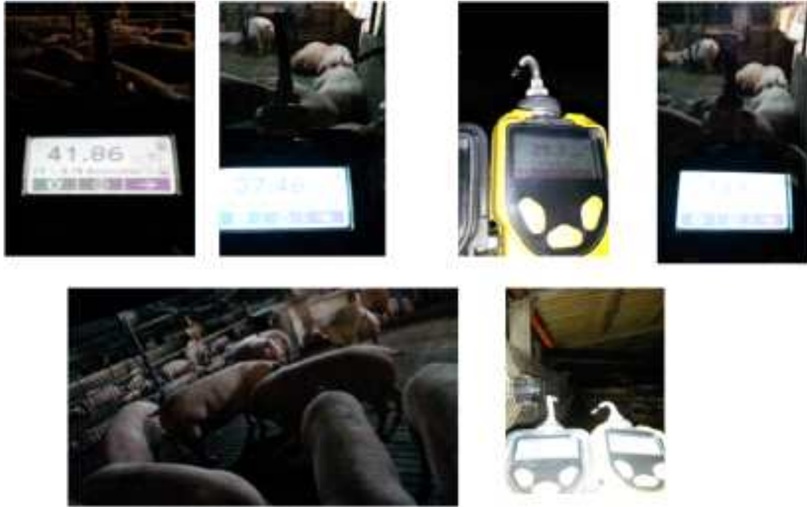
[그림 3-117] 실증테스트 돈사내의 암모니아(좌) 및 황화수소(우)농도
