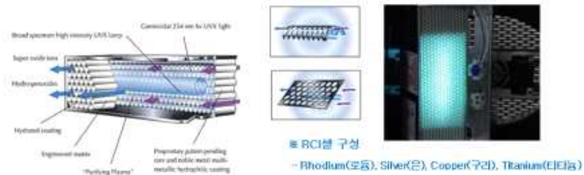
[그림 2-6] 광촉매 필터의 구조 및 적용 예시
