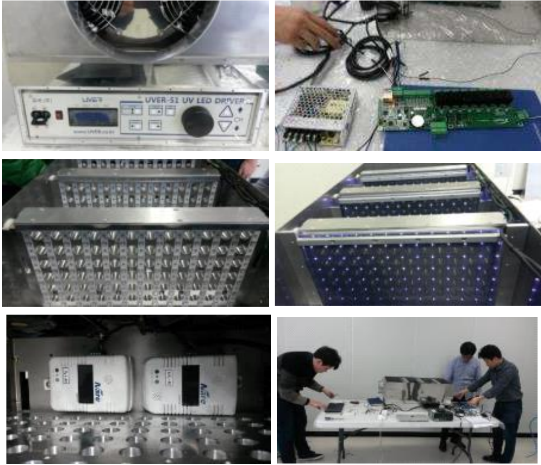
[그림 3-136] 광원모듈의 광량 Po값 변환 및 Fan 속도 단계별 CFM시험
