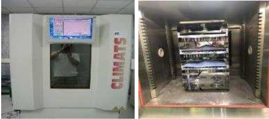
[그림 3-147] 고온동작시험, 고온고습방치시험
