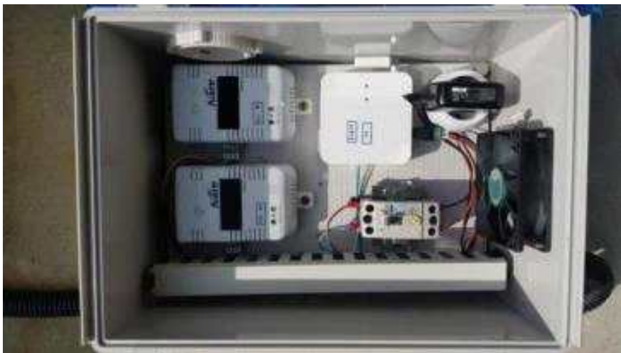
[그림 3-4] 센서와 모뎀을 연결한 합체를 돈사에 설치한 모습
