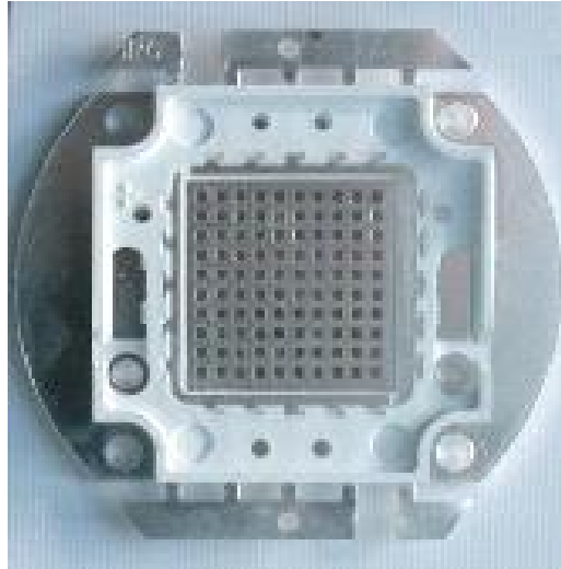
[그림 3-31] 촉매반응을 위한 고성능 UV LED 375nm-385nm 100W
