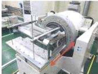
그림 5) 시험용 설치 사진: Y축
