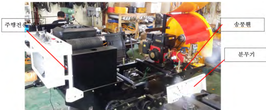
Fig. 13 본 과제에 적합한 방제기의 최종 구조
