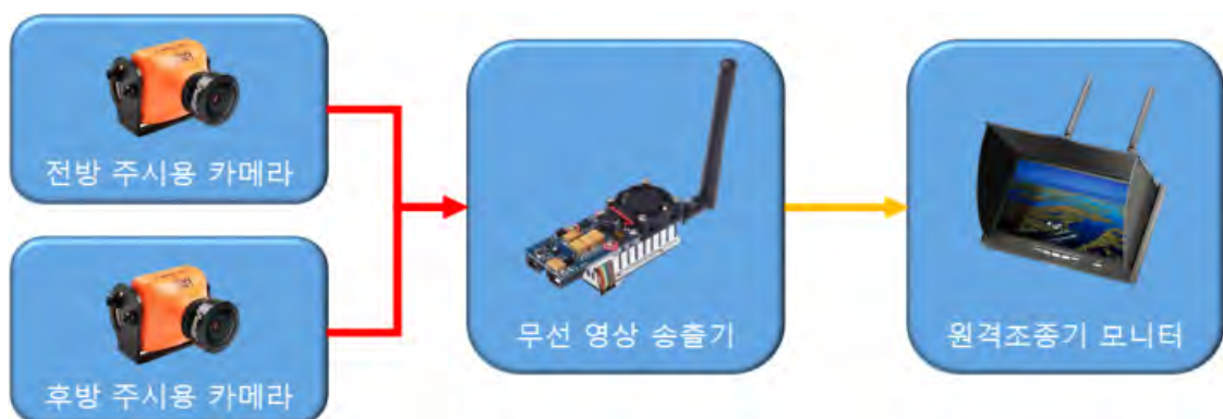
Fig. 28 전/후방 영상 수집 장치의 구성
