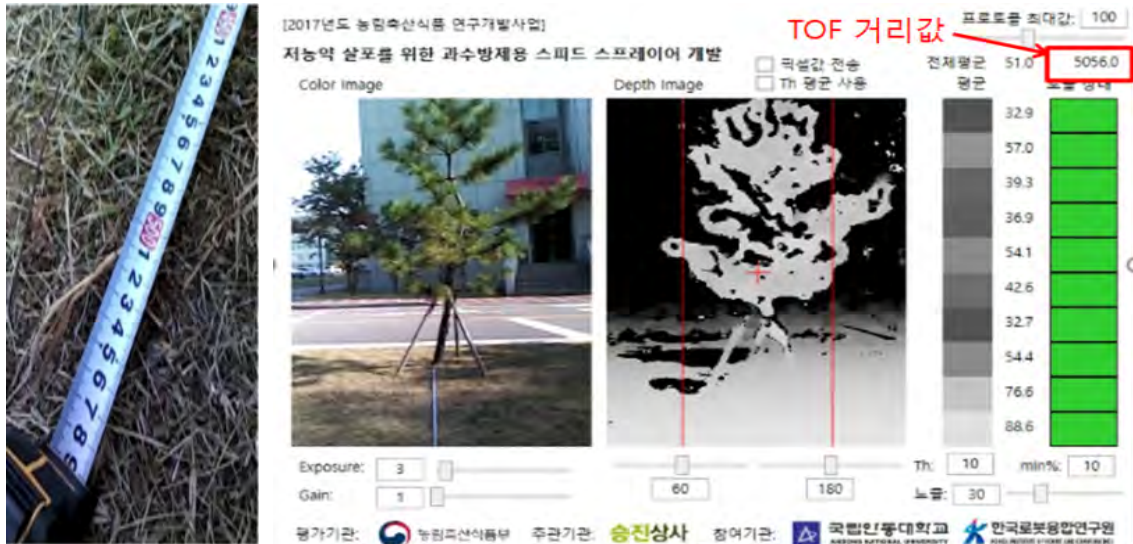
Fig. 24 IR Time Of Flight 실외 실험 실측거리(왼), TOF에서 취득된 거리 값(우)
