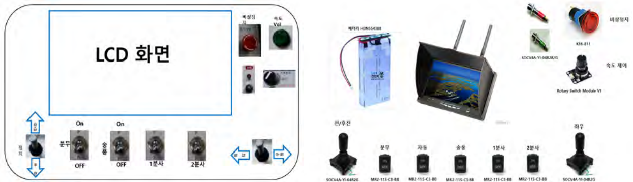
Fig. 41 실험용 원격제어기를 기반으로 구축된 휴대용 원격제어기의 구성
