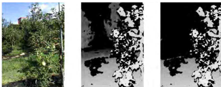
Fig. 27 과수원 및 실외 환경에서 실험 결과 (왼쪽부터 RGB, Depth 원본영상, 정규화적용결과)
