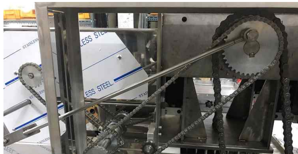
그림 3-5. 크랭크 방식 적용 및 제작
