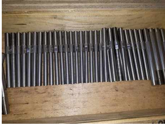
그림 3-14. 건대추 압출핀 설계 및 제작
