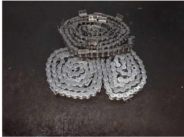
그림 3-10. SUS 표준형 어태치먼트 체인 규격 및 제작
