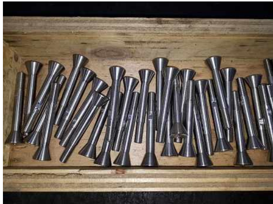
그림 3-15. 건대추 배출핀 설계 및 제작
