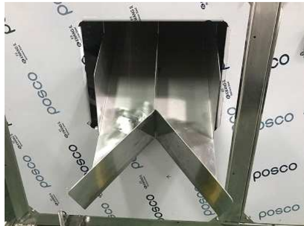
그림 3-23. 배출부 설계 및 제작
