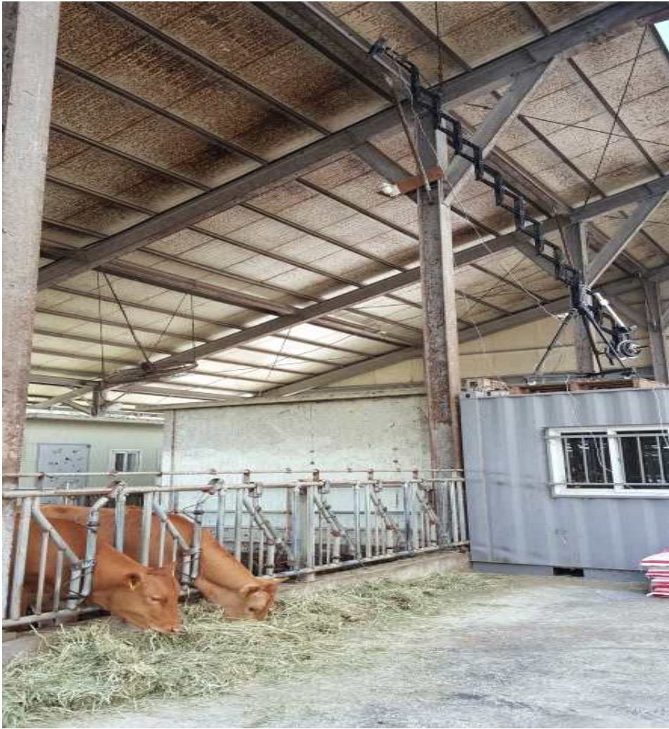
Figure 29. 지미짚에 연결된 열화상 카메라가 설치된 실험용 우방
