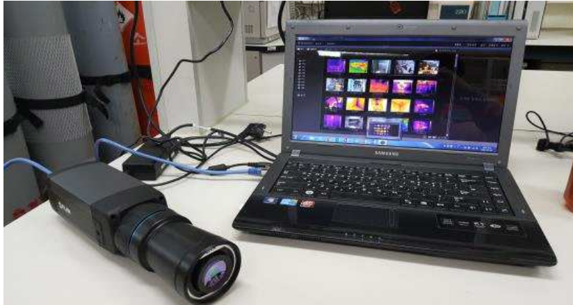
Figure 28. 실험에 사용된 열화상 카메라 (FLIR A615, FLIR, USA)
