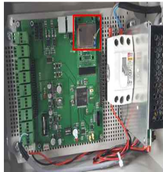
[LoRa 적용된 Board 에 Relay_module 결합]
