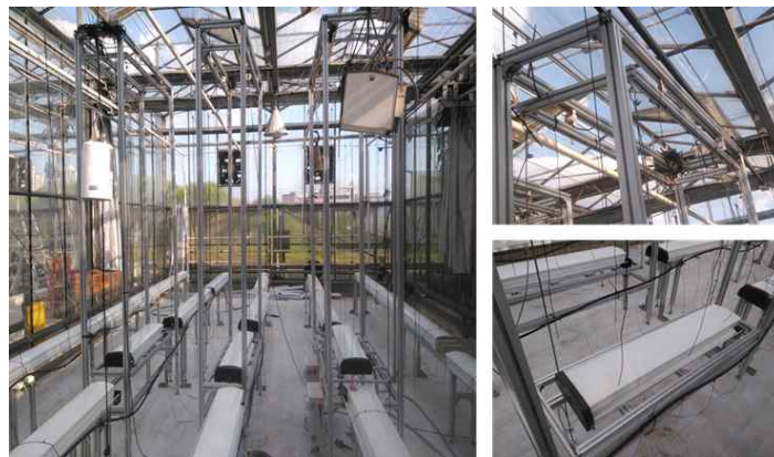
[ 작물 생체중 추정 실제 설치 예시 ]
