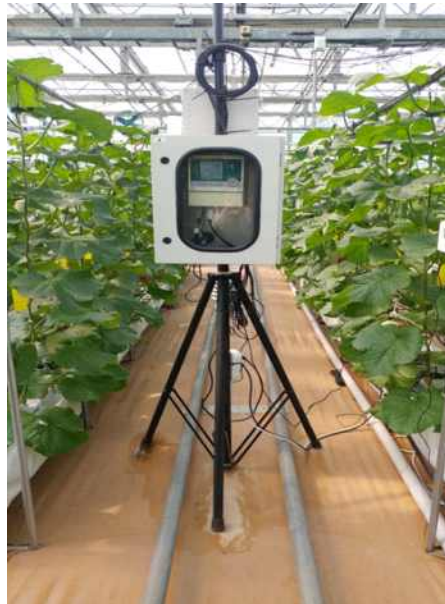
< 환경 계측용 기기 설치 내용(파프리카-좌, 멜론-우) >
