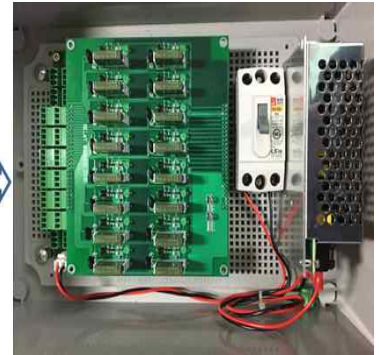
[LoRa 적용된 Board 에 Relay_module 결합]
