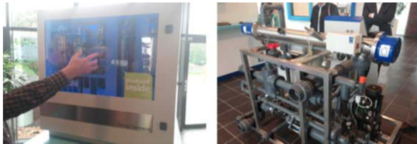
< Priva사 온실 환경 제어 시스템 및 관개용수 관리 시스템 >
