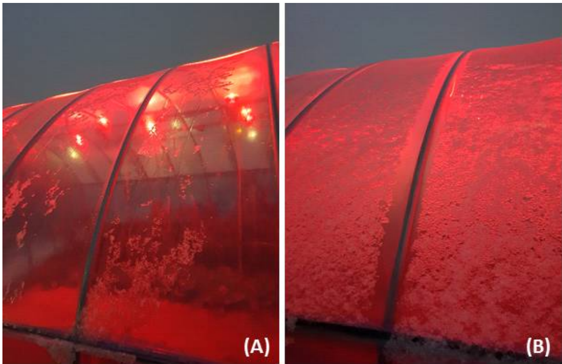
<그림 42> 적외선 램프 작동하에 기능성 비닐하우스 (A)와 일반 비닐하우스 (B)의 표면 상태
