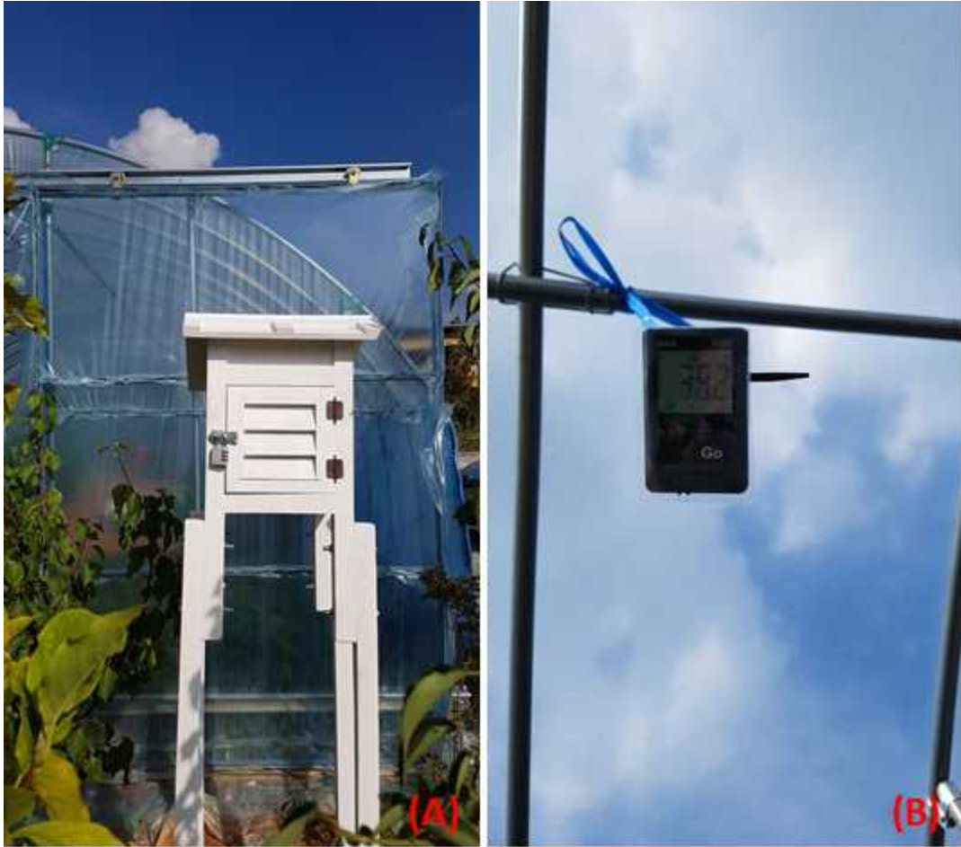
<그림 34> 기능성 및 일반 비닐하우스 간의 온,습도 측정을 위한 데이터 로거 설치
