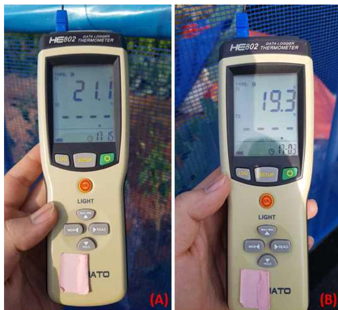
<그림 38> 기능성 비닐하우스 (A)와 일반 비닐하우스 (B)의 표면온도 측정
