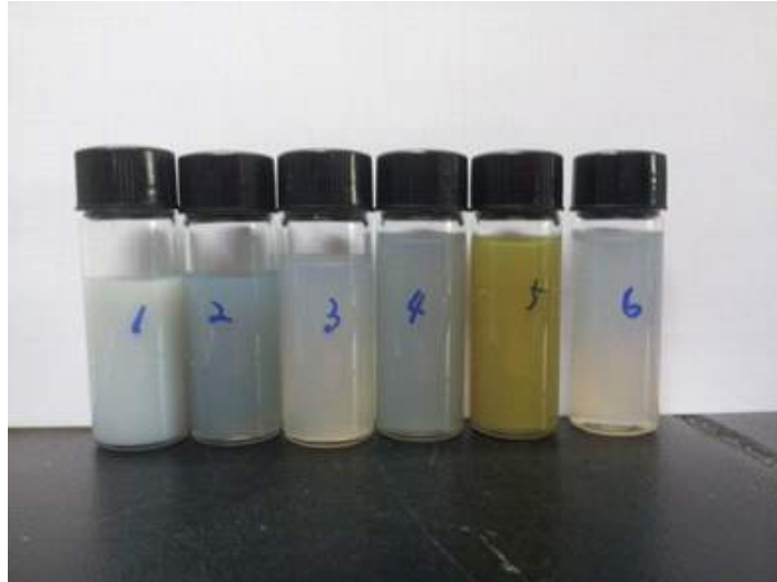
<그림 23> 근적외선 흡수 나노소재 Urethane base 코팅액 및 분산 안전성 테스트
