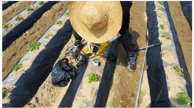
그림 2.2.37 토양수분 센서 삽입 후 밀도 정리 및 초기값 확인
