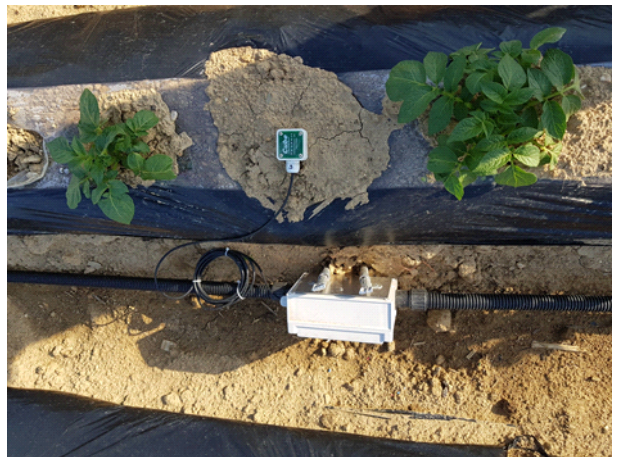
그림 2.2.38 토양수분 개별 센서 통신모듈 및 설치완료
