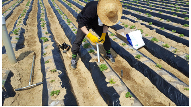
그림 2.2.36 토양수분 센서 천공 및 삽입
