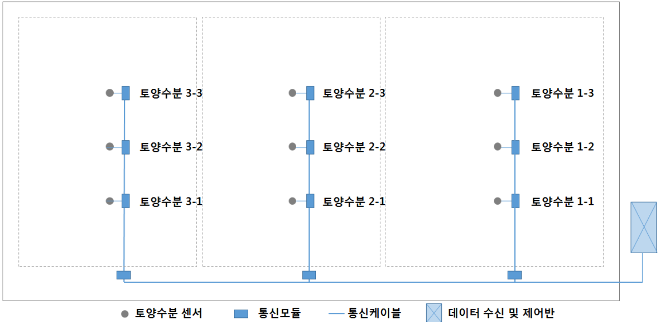
그림 2.2.35 토양수분 센서 및 제어시스템 개요
