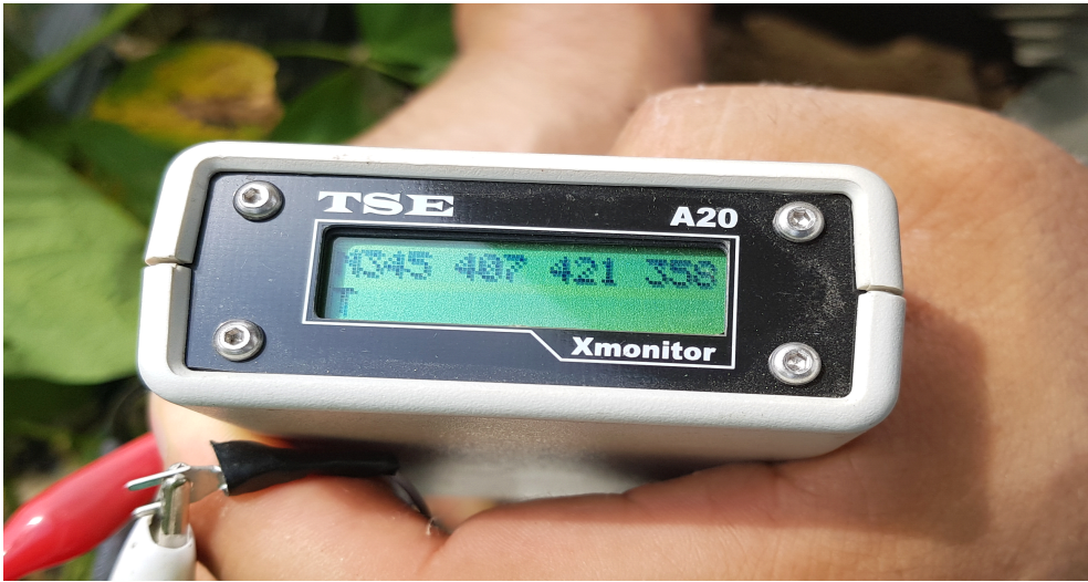
그림 2.4.13 스마트 토양수분 제어시스템 토양수분 센서 테스트
