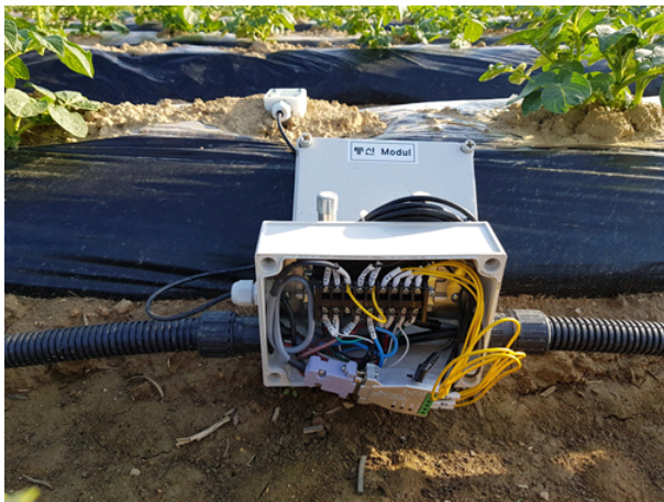
그림 2.2.38 토양수분 개별 센서 통신모듈 및 설치완료
