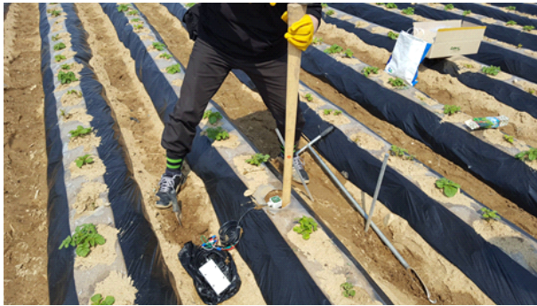
그림 2.2.37 토양수분 센서 삽입 후 밀도 정리 및 초기값 확인
