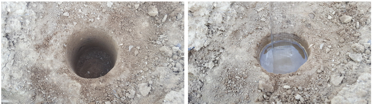
그림 2.2.13 테스트베드 투수계수 측정
