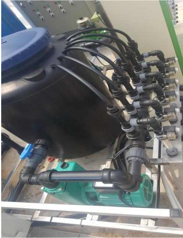
<배합통에 각 센서를 설치하여 EC 및 각 성분조성>
