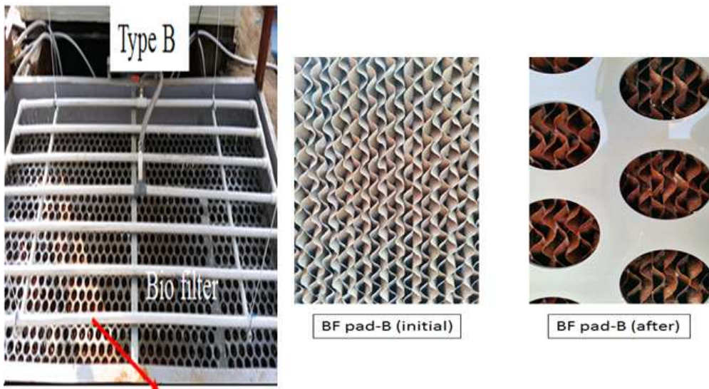
[그림 2.14d] B형 바이오필터 순환 장치
