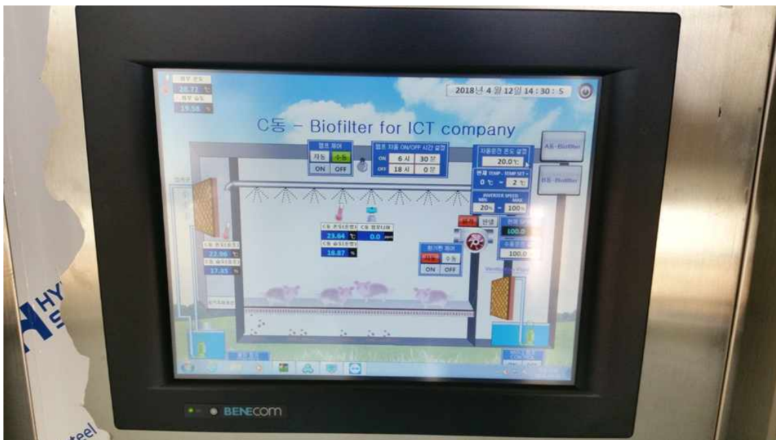
[그림 3.46] 사육실-바이오필터 구동제어와 모니터링 touch screen 컴퓨터 장치
