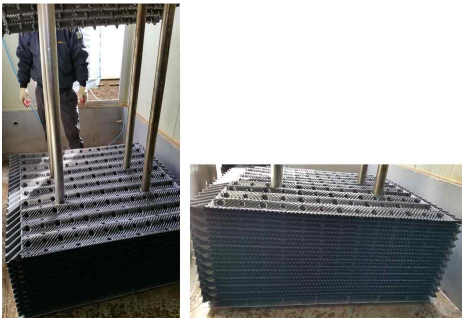
[그림 3.5] 개발 중인 수직형 바이오필터 제작과정
