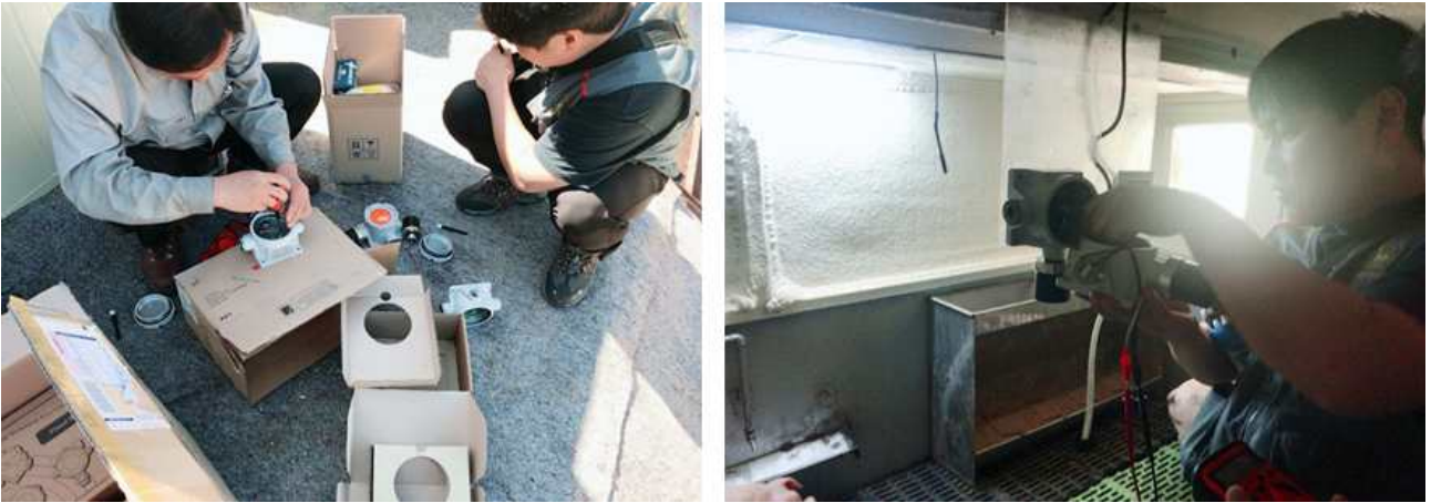
[그림 3.35] 모형돈사 A, B, C 암모니아 센서 설치
