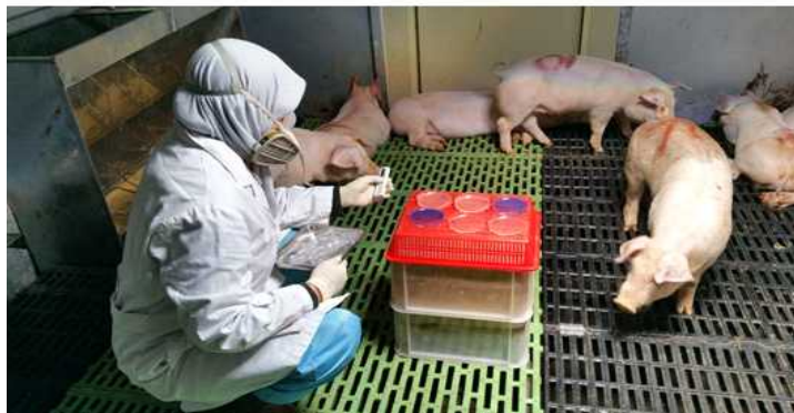
[그림 3.123] 모형돈사 공기 중 부유물질 농도 측정
