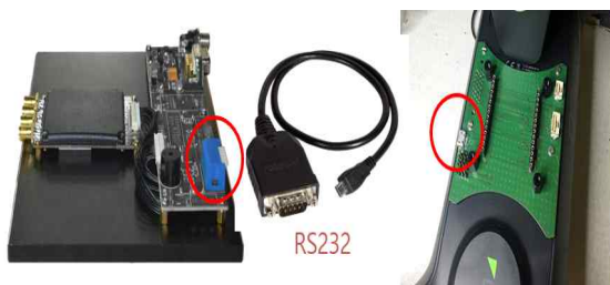
그림 34. RFID 수신기와 드론의 연결 방법
