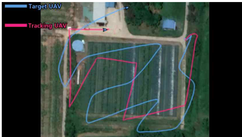
그림 261. 현장 실증을 통한 실험 결과: (파란색)소형 무인항공기의 위치 (빨간색)추적용 무인항공기의 위치
