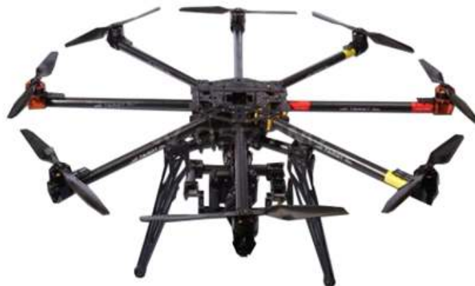
그림 133. 자체 제작한 추적용 무인항공기
