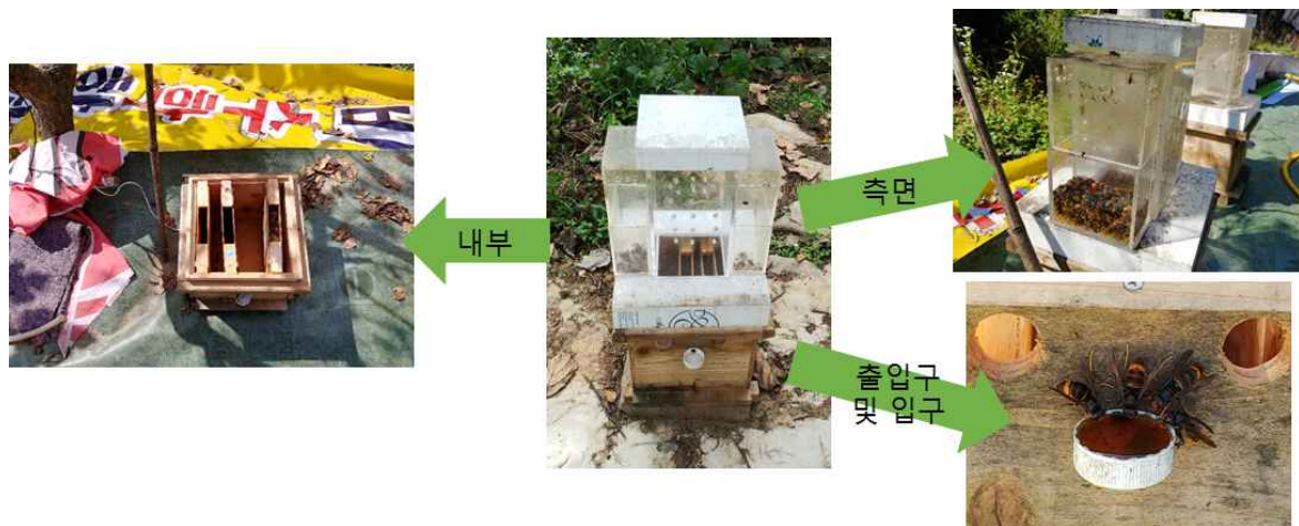
그림 243. 대형 포획기 구조 및 사진
