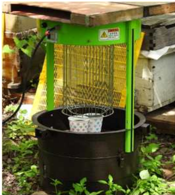
그림 224. 간헐적 고압 전류 방출로 인한 전기 충격식 대형포획기 시제품 2안
