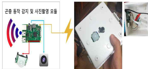
그림 227. 조기감지장치의 영상처리 시스템 모듈 개념도 및 조립된 시작품
