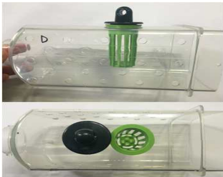
그림 78. 1,2차에 걸쳐 최종적으로 제작된 유인물질 탑재가 추가된 시제품의 사진
