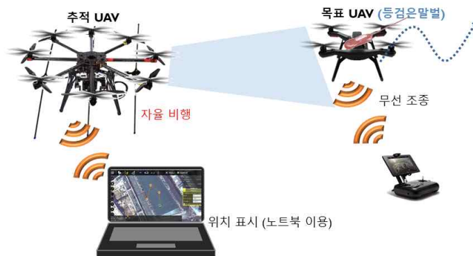
그림 145. 두 대의 무인항공기를 이용하는 추적 검증 실험 개념도
