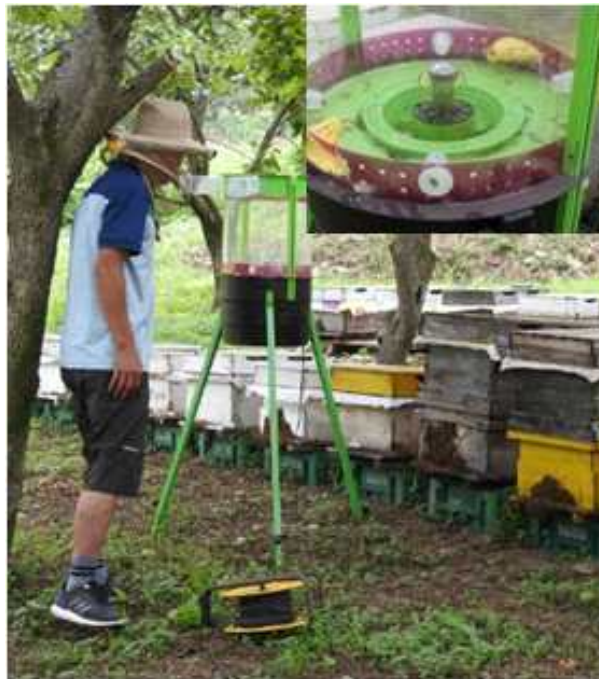
그림 223. 지속적인 유인제 발향 및 확산이 가능한 대형포획기 시작품 1안
