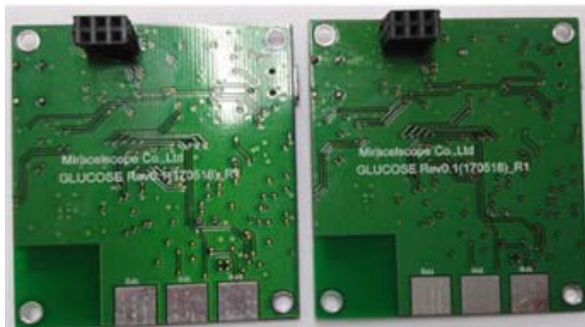
그림 49. 전용 IC를 사용하여 제작된 보드의 Bottom Layer PCB
