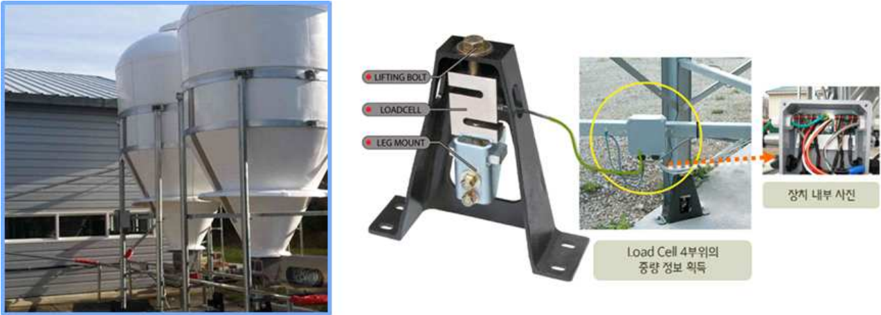
테스트베드 내 사료빈 설치 현황 (좌), 로드셀 (우)
