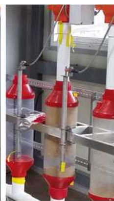
에코시스템 급이기 연속공정 -좌:콘트롤부 상단에 [test ch]스위치중 1번을 위로 올려 ON -우:터치센서를 테이프로 고정하면 모터연속가동됨
