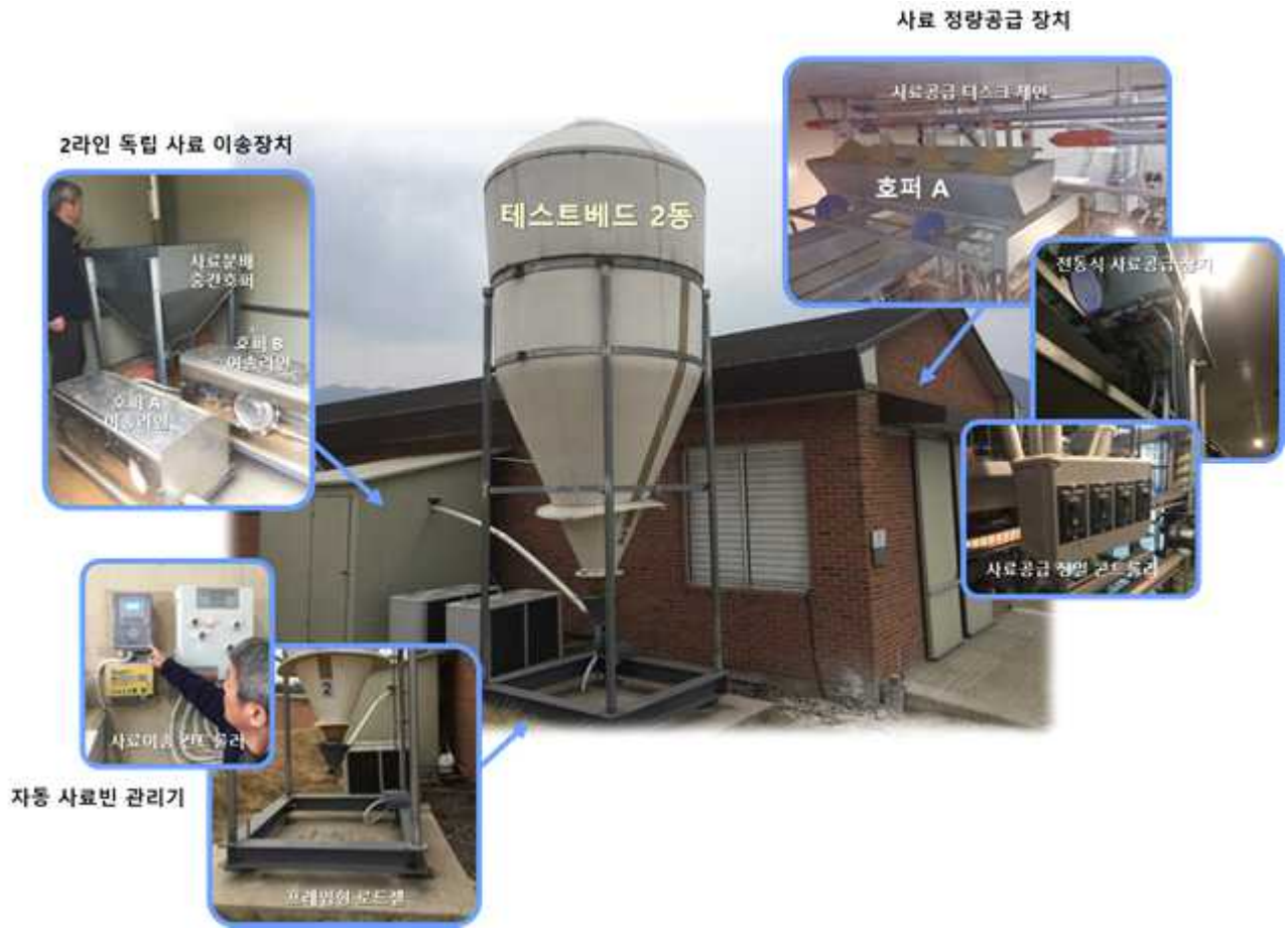
테스트베드 2동 스마트팜 솔루션 구성요소 (자동 사료빈 관리기/2라인 독립 사료 이송장치/사료 정량공급 장치)
