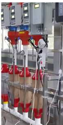
코마스 급이기 연속공정: 무한반복 타이머를 이용한 -7분 ON (10kg 사료토출)/5초 OFF cycle을 무한반복
