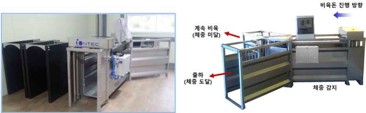
테스트베드 내 출하돈 선별기 설치 현황 (좌), 출하돈 선별기 작동 방식 (우)
