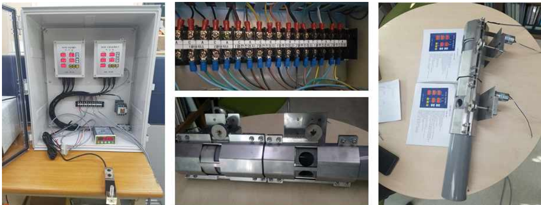
사료 이송라인 자동 개폐기 작동 시험
