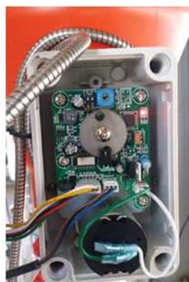
에코시스템 급이기 연속공정 -좌:콘트롤부 상단에 [test ch]스위치중 1번을 위로 올려 ON -우:터치센서를 테이프로 고정하면 모터연속가동됨
