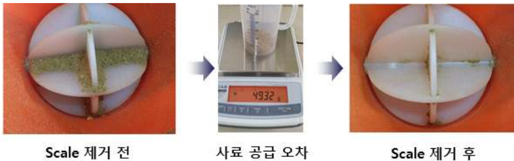
임펠러 구조에 따른 사료 스케일 형성으로 정량 공급 오차 발생
