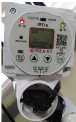
코마스 급이기 연속공정: 무한반복 타이머를 이용한 -7분 ON (10kg 사료토출)/5초 OFF cycle을 무한반복
