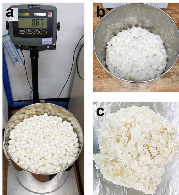
그림 11. 증류수를 이용한 실크 피브로인 대량 정련 사진. a. 정련 전 누에고치 사진(0.87kg). b. 대량 정련 후 세리신이 제거된 실크 피브로인 사진. c. 건조된 실크 피브로인 사진.
