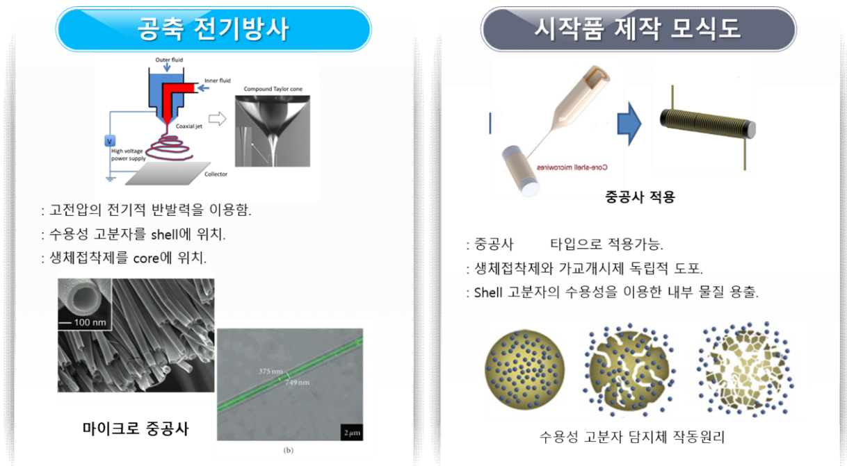
그림 4. 공축전기방사와 수용성 담지체 제작방법 일체형 혈관문합기 제작 방법과 수용성 담지체의 수분접촉 시 작동원리
