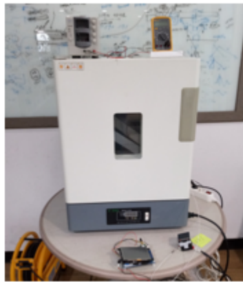
그림 168 온도 측정값의 정밀도 및 선형성 확인 환경
