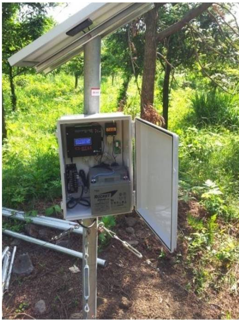
그림 5 선행연구로 개발한 시스템 데이터 수집 및 송신장치, 꿀벌 양봉사육상에 소비형태로 삽입 장착
