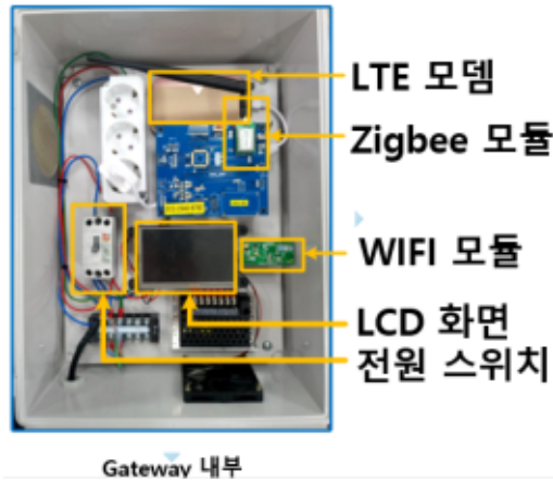
그림 151. Gateway 내부 구성
