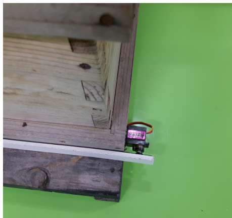
그림 110 별통에 장착된 소문개폐용 Servo
