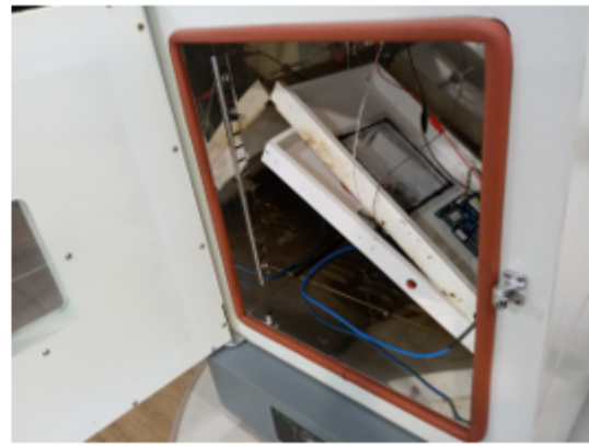
그림 168 온도 측정값의 정밀도 및 선형성 확인 환경
