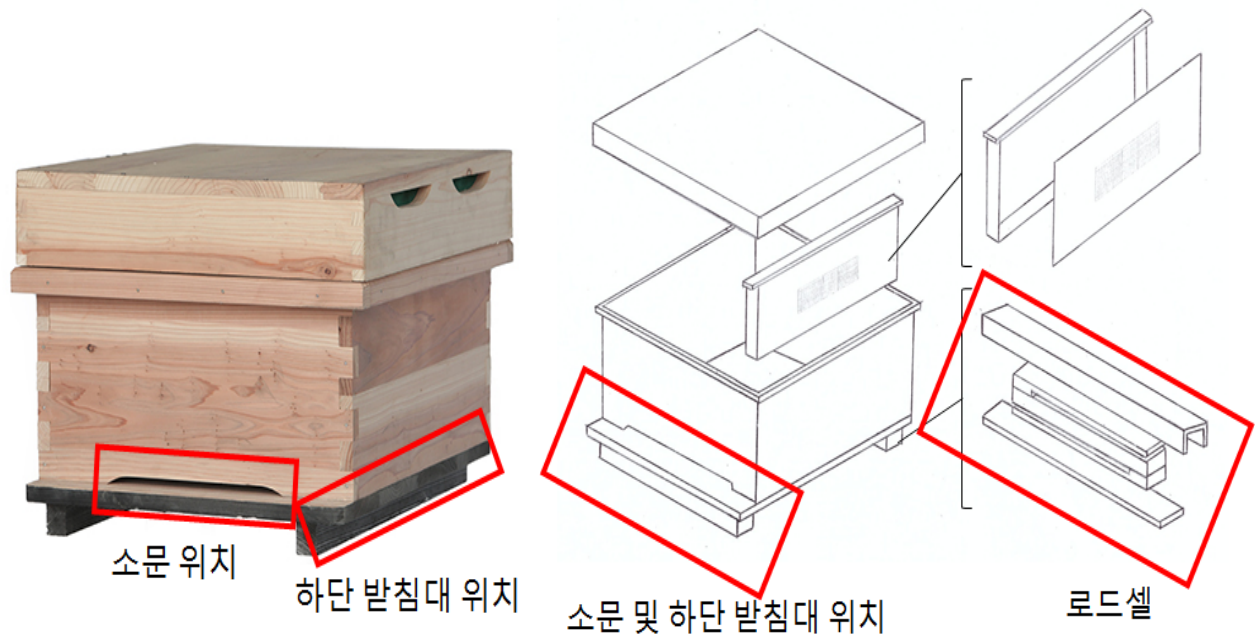
그림 67 무게 측정 장치가 후방 하단 받침대를 대신하는 새로운 형태의 양봉상
