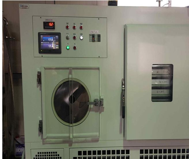
그림 16. 동결건조에 사용된 생산용 동결건조기
