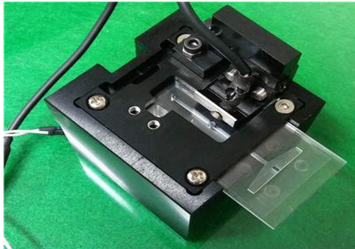
그림 33. 시스템 미세 유체칩 삽입부 및 미세 조정 가능 검출부 (Photodiode) 사진
